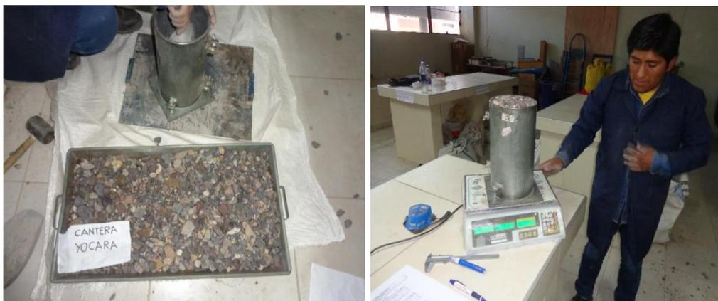
**Figura 15:** Peso unitario suelto y compacto del agregado grueso
