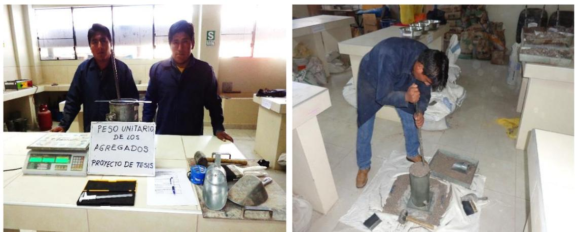
**Figura 14:** Peso unitario suelto y compacto del agregado fino
