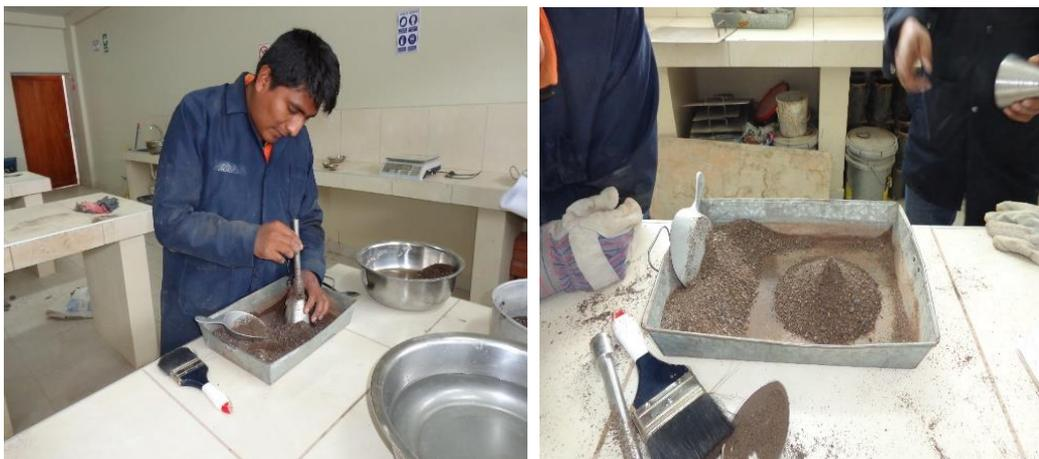
**Figura 10:** La muestra de agregado fino SSS, se coloca en un cono, haciendo el proceso hasta que se desmorone al retirar el cono
