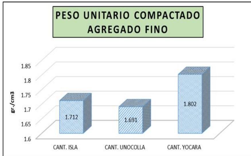
**Figura 41:** Cuadro comparativo peso unitario compactado del agregado fino
