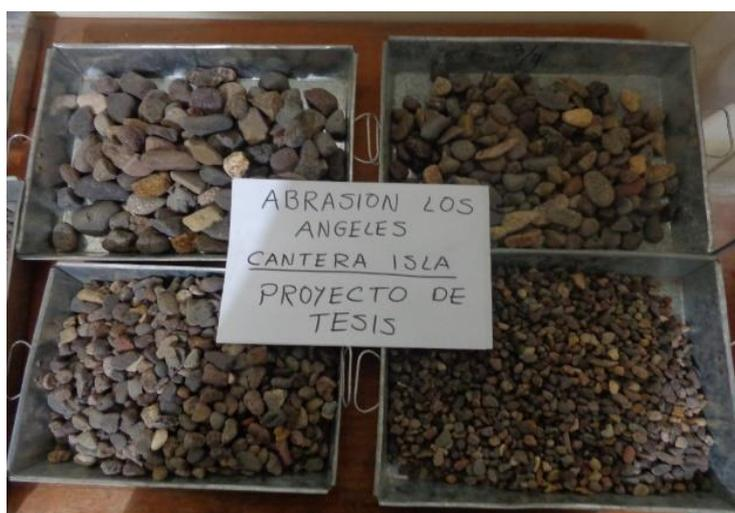
**Figura 21:** Agregados retenidos en los tamices para ensayo de desgaste
