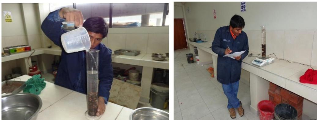
**Figura 13:** Peso específico y absorción de agregado grueso
