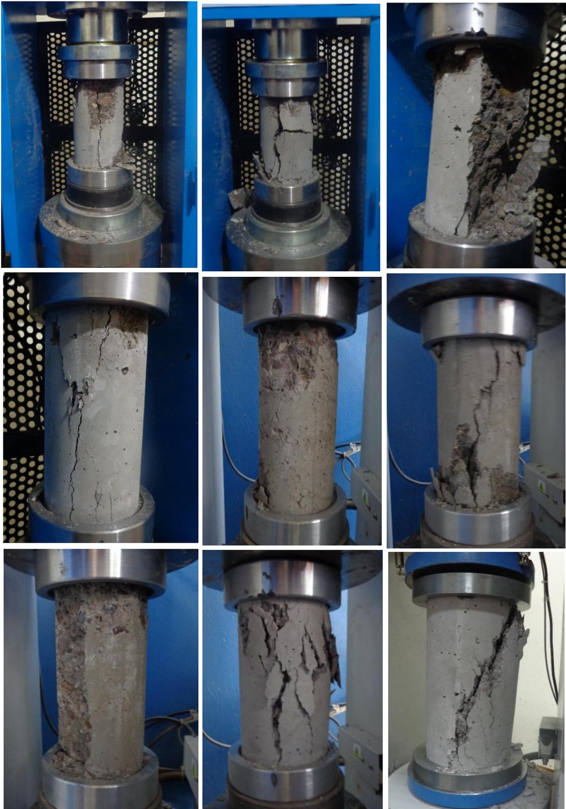
**Figura 33:** Tipos de fallas de las probetas elaboradas
