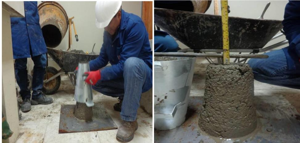
**Figura 30** Ensayo de revenimiento o asentamiento en el cono de Abrams
