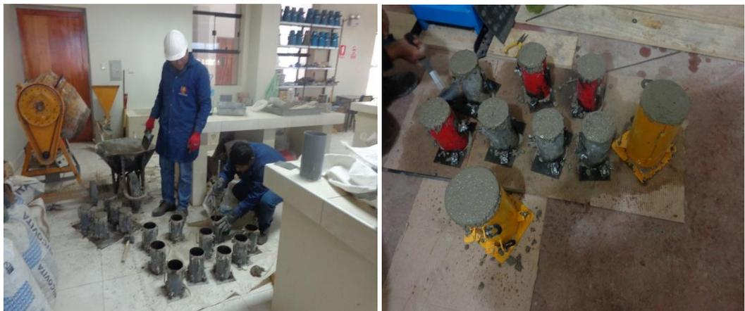
**Figura 28:** Elaboración de probetas cilíndricas
