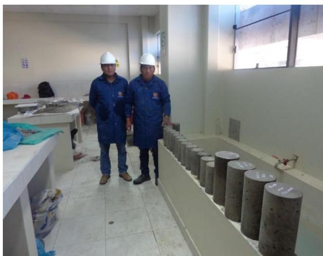
**Figura 29:** Curado de especímenes de prueba
