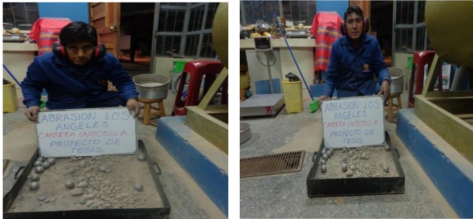
**Figura 23:** Ensayo de desgaste por abrasión de Los Ángeles
