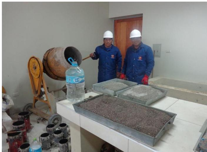
**Figura 26:** Dosificación de materiales por peso
