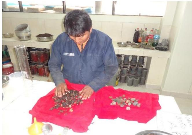
**Figura 12:** Agregado grueso en estado S.S.S
