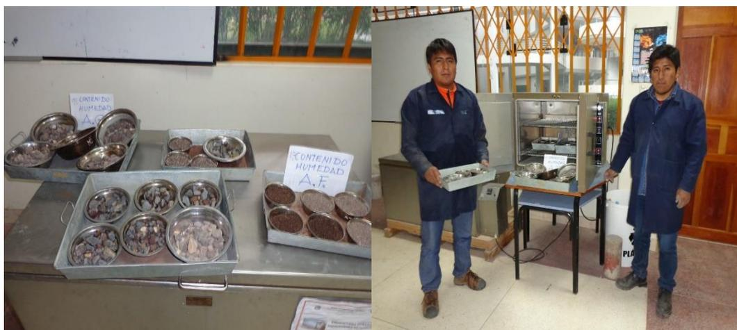
**Figura 9:** Contenido de Humedad - Agregado Grueso y Agregado Fino
