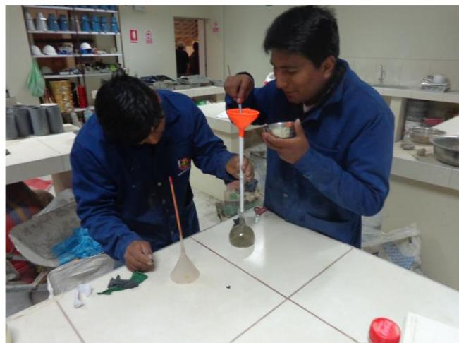
**Figura 20:** Colocación del cemento en el frasco le chatelier
