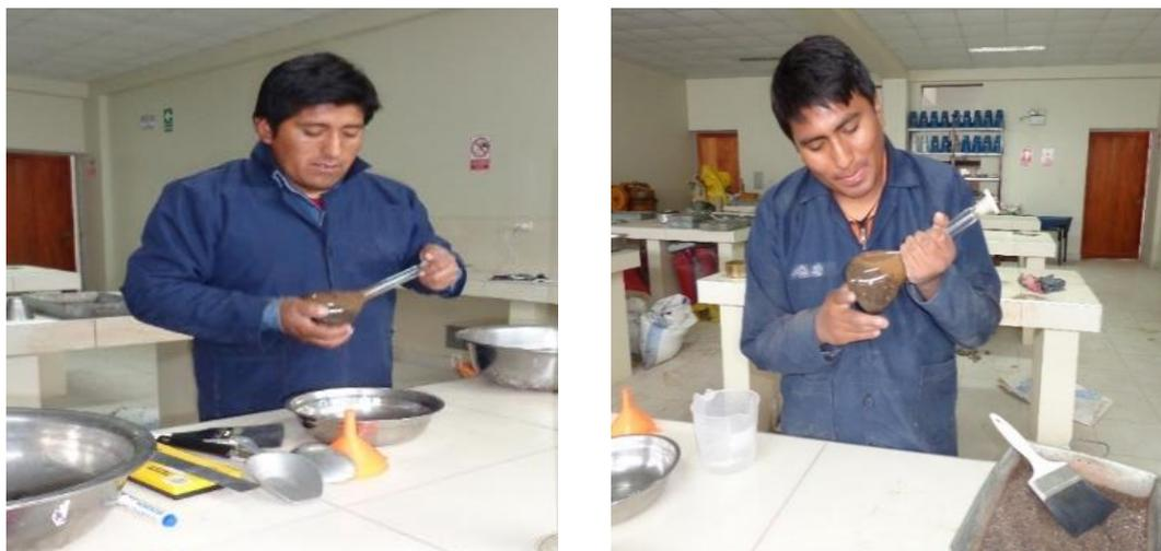
**Figura 11:** Llenado del agregado fino al frasco y ejecución del giro de la fiola
