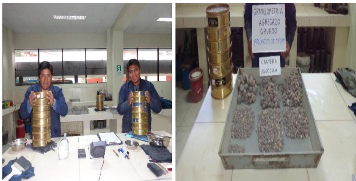
**Figura 16:** Análisis Granulométrico – A. Fino y A. Grueso
