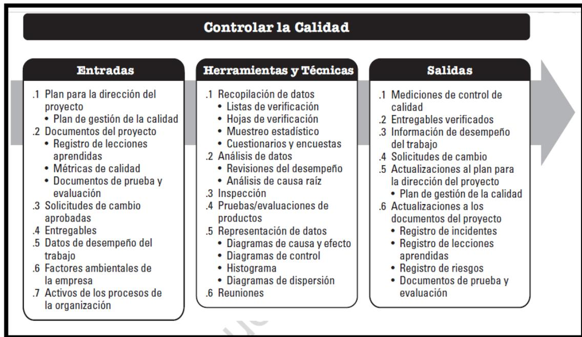
**Figura 11 :** Proceso de Control de la Calidad.
