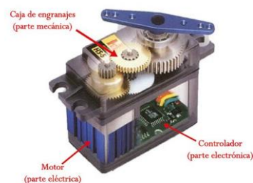
Figura 3.4 Diseño mecánico de servomotor
