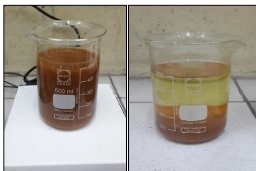
Foto 07 imagen de la prueba N° 5 a pH 12.31 y con adición de FeCl 3 a 11.45
