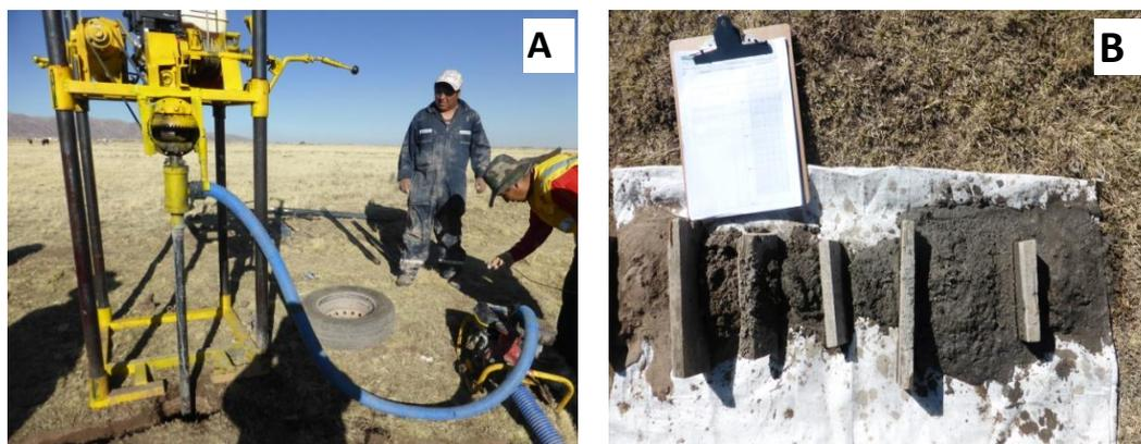
*Figura 6.* Muestreo de Sedimentos. A. máquina perforadora, con brocas de 4", B. lodos extraídos según el cambio de litología.
