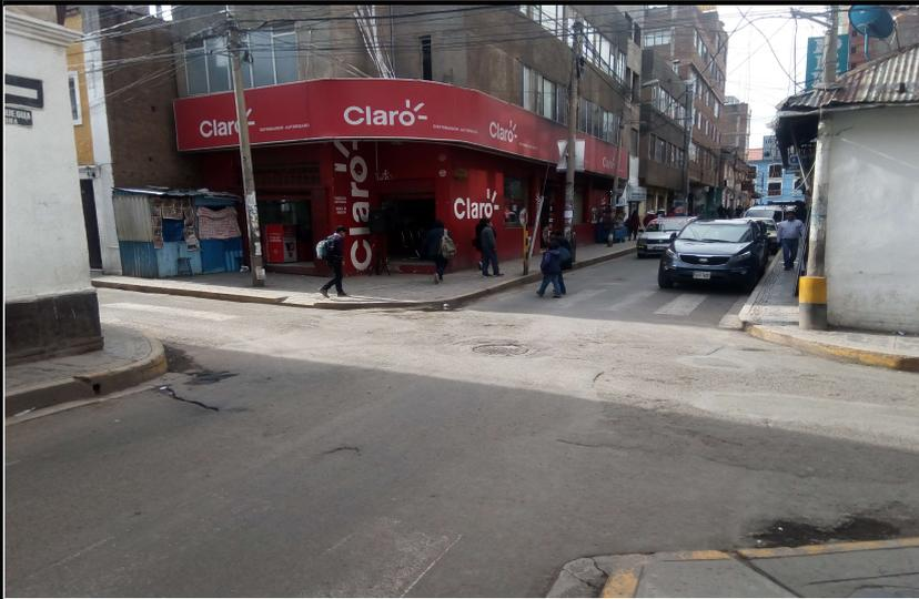
No existen rampas para discapacitado y las veredas no tienen el ancho mínimo para la circulación
