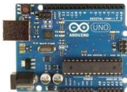
Figura N° 2.34: Tarjeta arduino UNO
