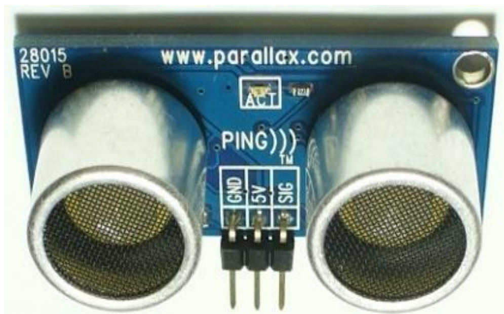
Figura N° 2.37: Sensor digital de distancia ping)))
