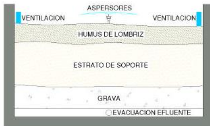
Figura 3. Capas del lombrifiltro
