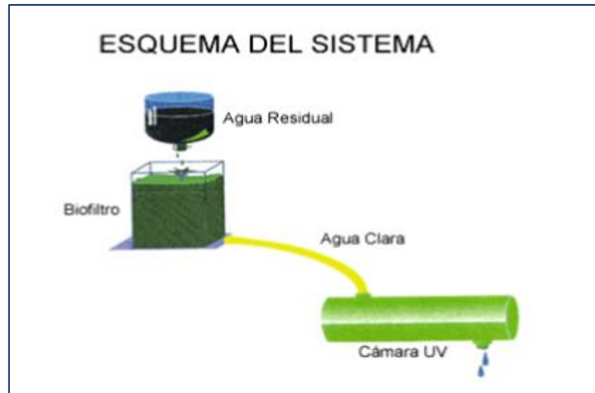
Figura 2. Esquema del sistema Tohá (lombrifiltro)
