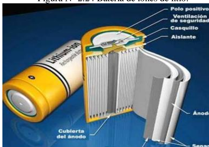
Figura N° 2.24 Batería de iones de litio.
