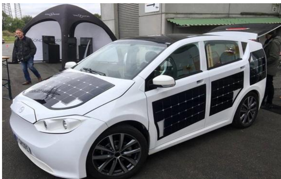
Figura N° 2.6 Vehículo eléctrico solar propulsado mediante energía fotovoltaica.
