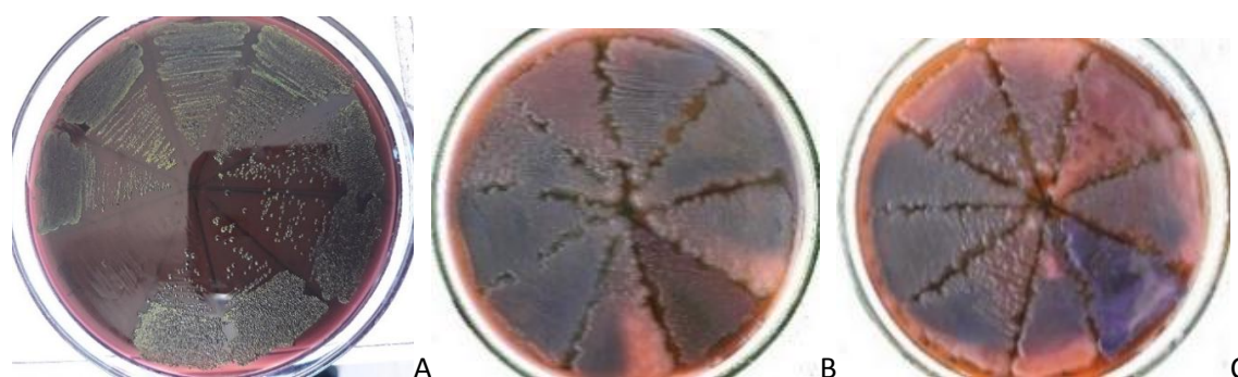
Figura 24. Resultados obtenidos por el metodo de la determinacion del Numero mas Probable para Coliformes fecales y totales ( test de aislamiento en agar EMB). A (cisterna), B (mitad del Estanque), C (Salida), de la muestra de agua de la piscina Paraíso, julio – noviembre del 2018.
