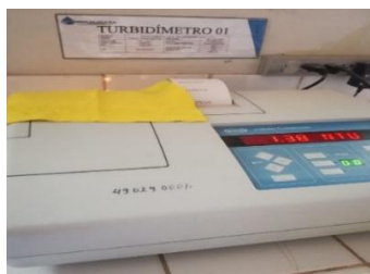
Figura 5. Medición de la turbiedad de las muestras de agua de piscinas utilizando el equipo HACH, 2100AN turbidimotor en el laboratorio de SEDA – Juliaca. Julio- noviembre 2018.
