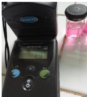
Figura 6. Medición del cloro residual in situ de la muestra de agua de piscinas con el equipo HACH, mediante el método del DPD. Julio – noviembre, 2018.
