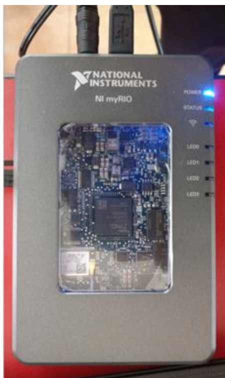
Figura 3.35. Fotografía de la tarjeta NI-myRIO.
