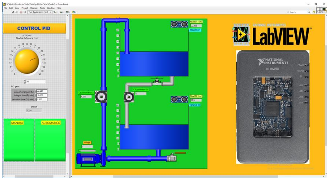
Figura 3.53. Scada del controlador PID.
