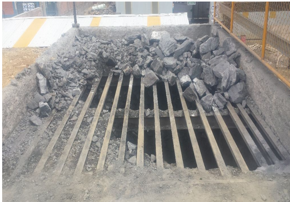
FIGURA N° 8: Foto de la tolva de gruesos parte superior, Planta Geza Minerales Asis.
