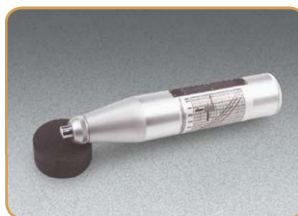
Figura 64: Martillo para pruebas de concreto
