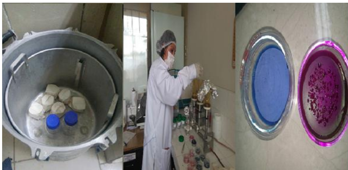
Figura 6. Esterilizando las placas, Vaciando 100ml de la muestra en el vaso de filtro y conteo de colonias de color rojo para coliformes totales en UFC/100ml y de color azul para coliformes termotolerantes en UFC/100m.
