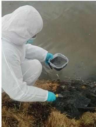
**Ilustración 2: Toma de muestras de lodo residuales de la laguna de estabilización secundaria de la ciudad de Juliaca - Puno – Perú**
