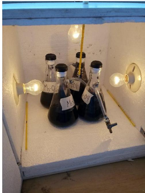
**Ilustración 7: Proceso de digestión anaerobia termofílica en el laboratorio acuática de la Facultad de Ciencias Biológicas UNA –Puno**
