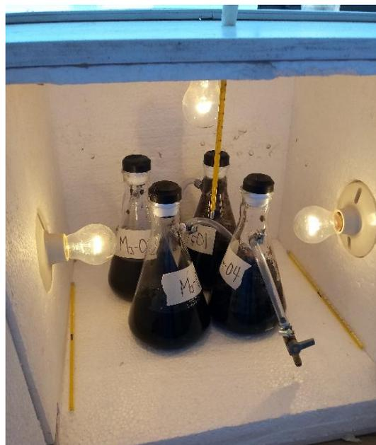
**Figura 4: Proceso de digestión anaerobia termofílica**
