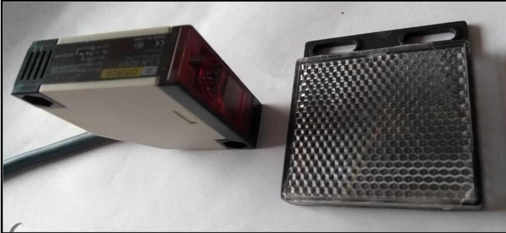
Este tipo de sensor requiere para su funcionamiento de un prisma, el cual debe ubicarse en forma alineada respecto del sensor.
