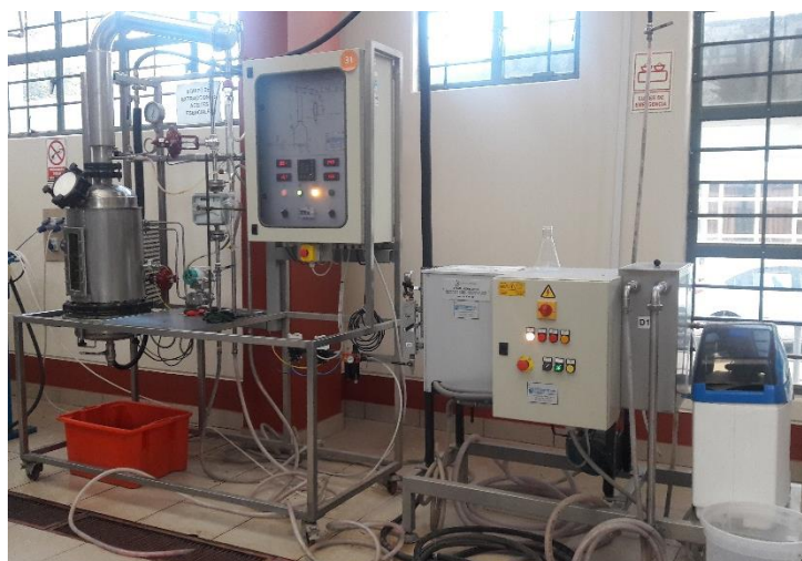
Figura 11: Equipo de destilación por arrastre con vapor.
