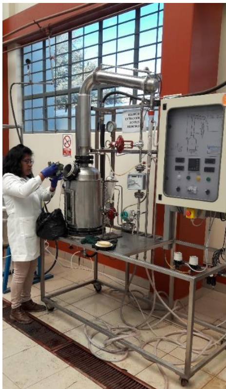
Fotografía D. 13: Extracción de Arrastre a vapor de la muestra de altamisa ( Franseria artemisioides ).
