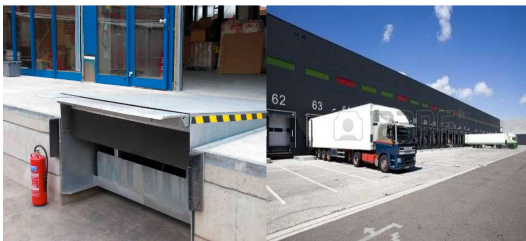
FIGURA 2.15: Rampa hidráulica y camiones pesados
