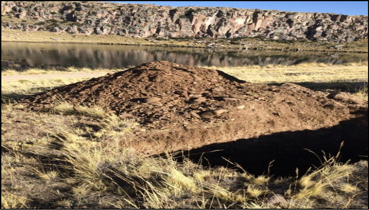
Foto 15: Una de las 8 muestras de las Calicatas que se hicieron en la zona de la Presa HUAYLLUMAYO
