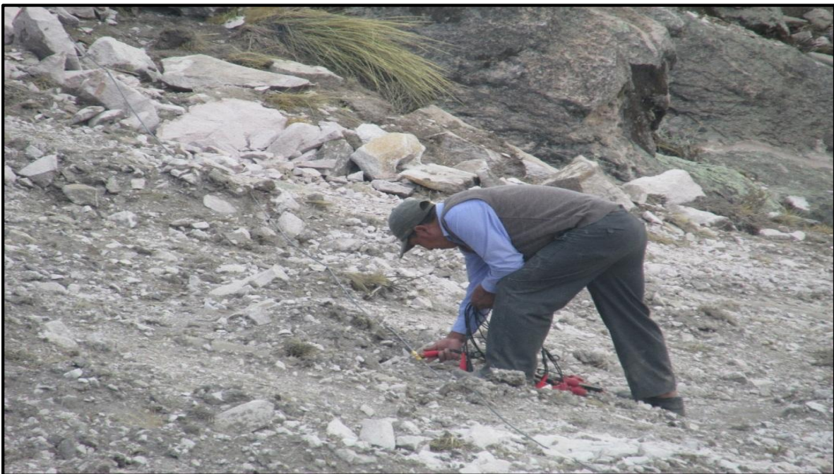
Foto 10: Instalando los geofonos para las pruebas respectivas
