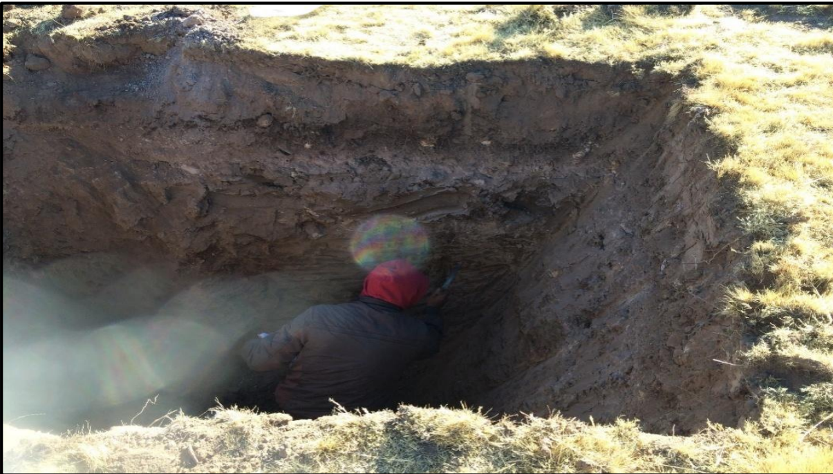
Foto 16: Geólogo tomando muestras de tierra en una de las calicatas
