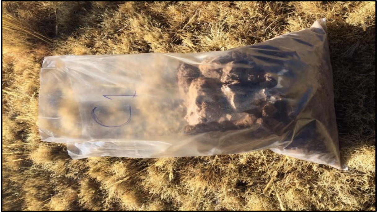
Foto 17: Una de las Muestras de Tierra de la calicata que se hicieron en la zona de la presa existente
