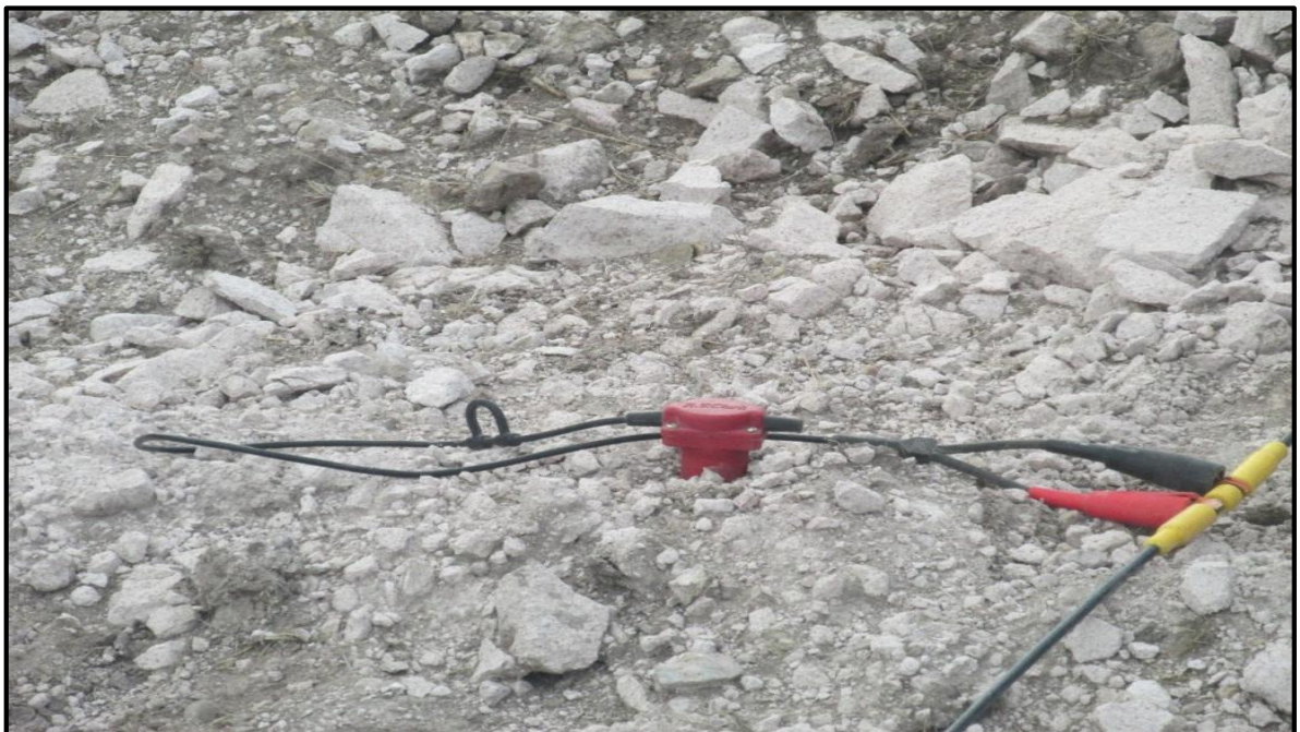
Foto 12: Lectura de datos del geofono
