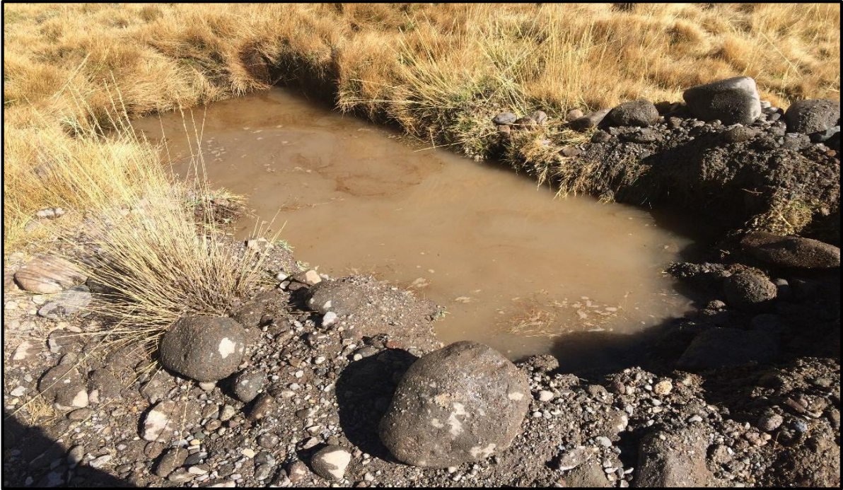
Foto 19: Una de las calicatas donde se llegó a la Napa freática
