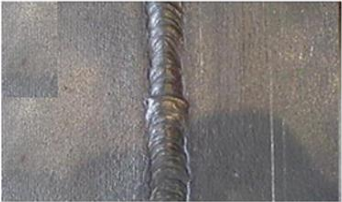
Figura N° 34: Cordón de soldadura sin efecto
