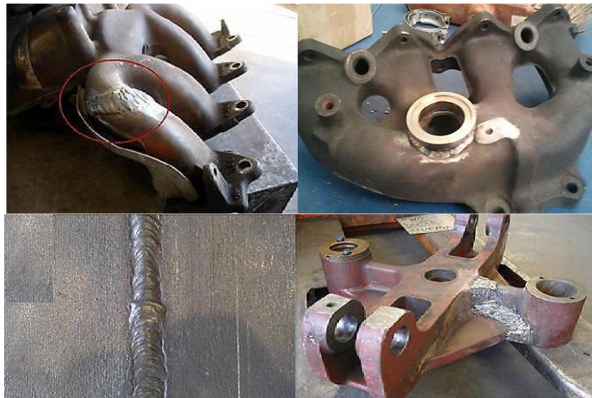
Figura N° 30: Cordón de soldadura depositado por el proceso SMAW
