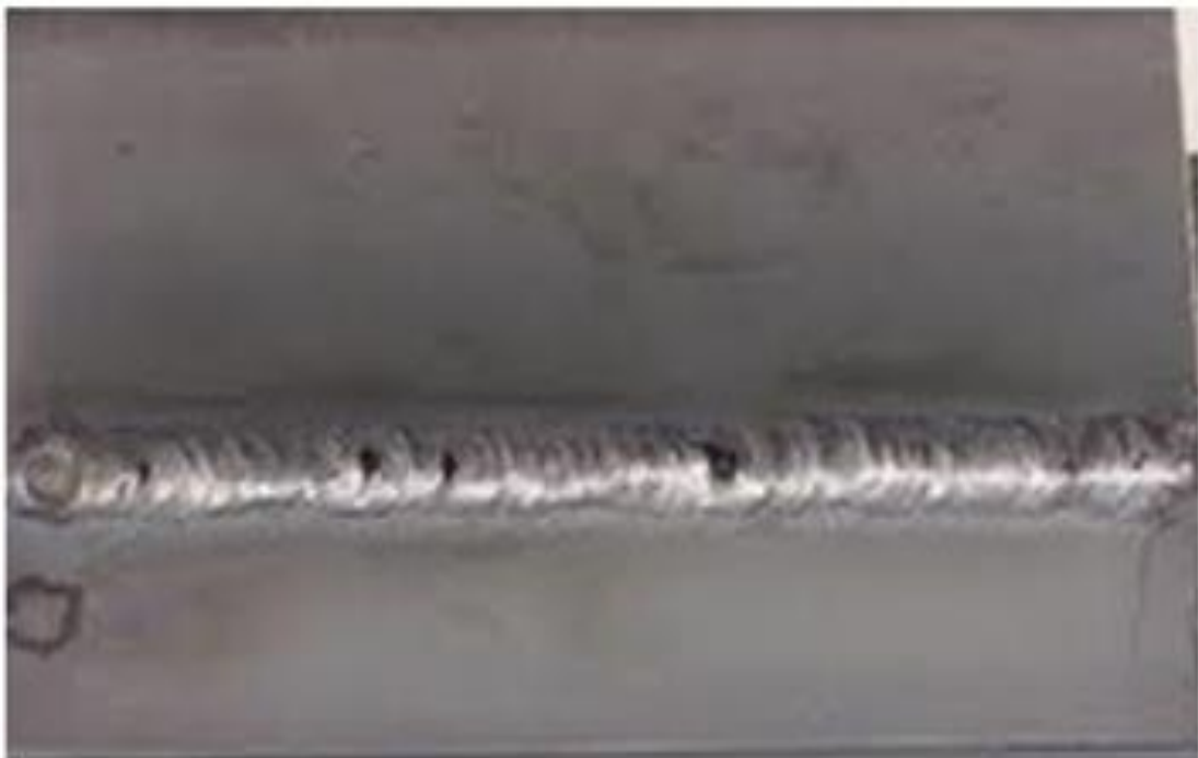
Figura N° 35: Cordón de soldadura con defecto
