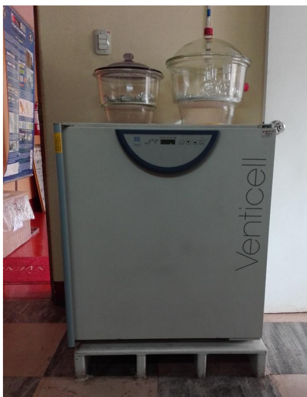
Figura 17. Estufa para la determinación de materia seca, marca: Venticell, modelo: LSIS-B2V/VC111, calibración: Gesmin. Laboratorio del IMARPE.
