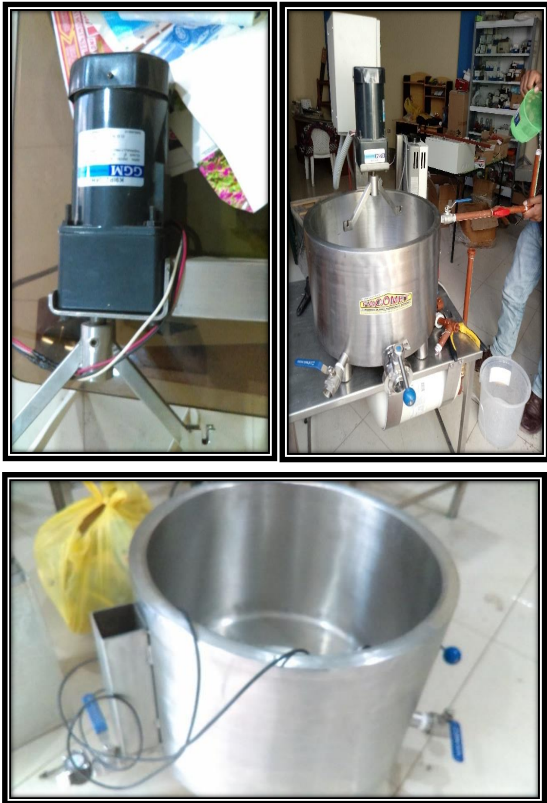
Imagen 8. Motorreductor de marca GGM y olla enchaquetada ya ensamblada
