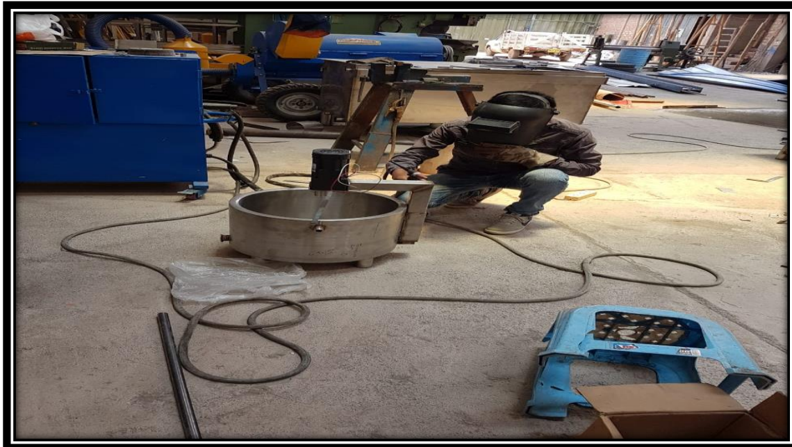
Imagen 4. Proceso de constructivo del equipo de tratamientos térmicos.
