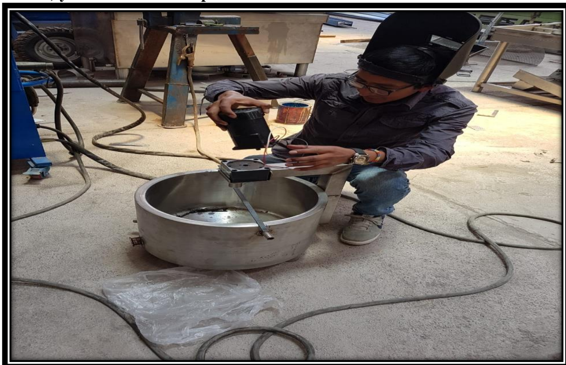
Imagen 5. Proceso de constructivo del equipo de tratamientos térmicos (tanque reactor) y la colocación del soporte del motorreductor.
