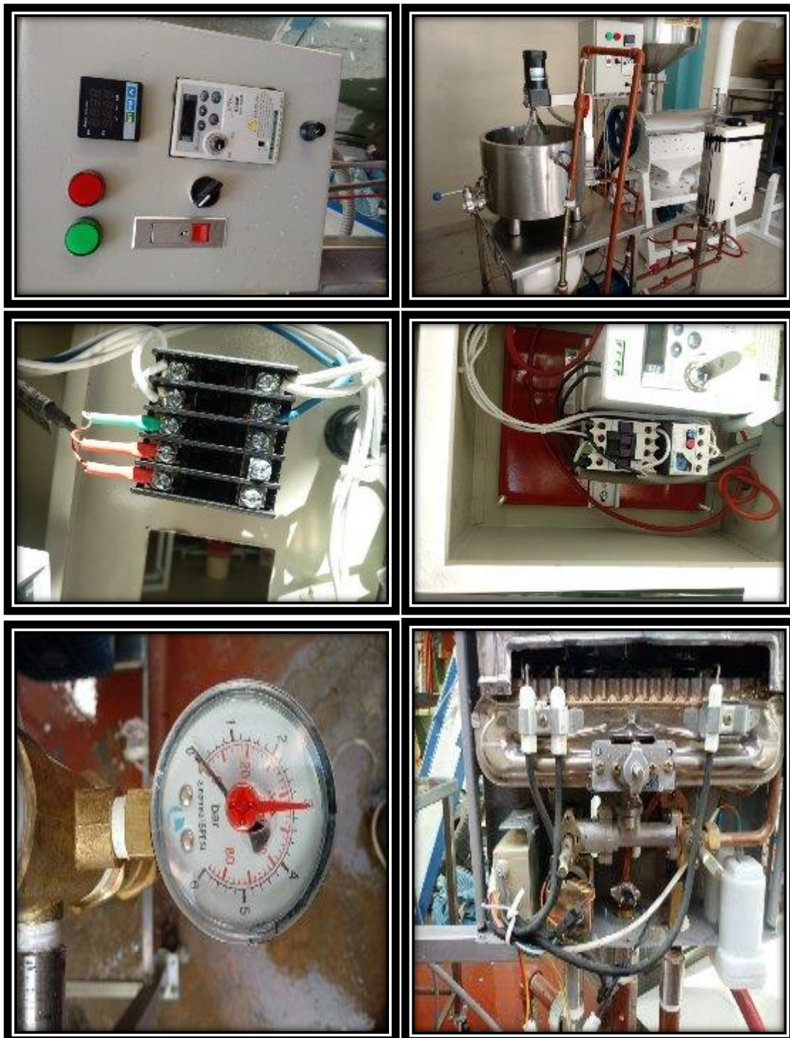
Imagen 10. Accesorios adicionales del equipo como el tablero de control, quemador sistema de control electrónico Arduino y sensores de temperatura.
