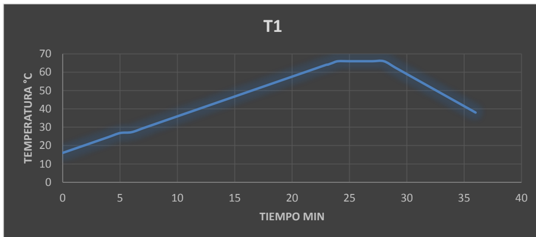
Figura 18. Tratamiento 1 comportamiento de la temperatura con respecto al tiempo de pasterización a una temperatura de 66°C por 5 minutos a 15 RPM de agitación
