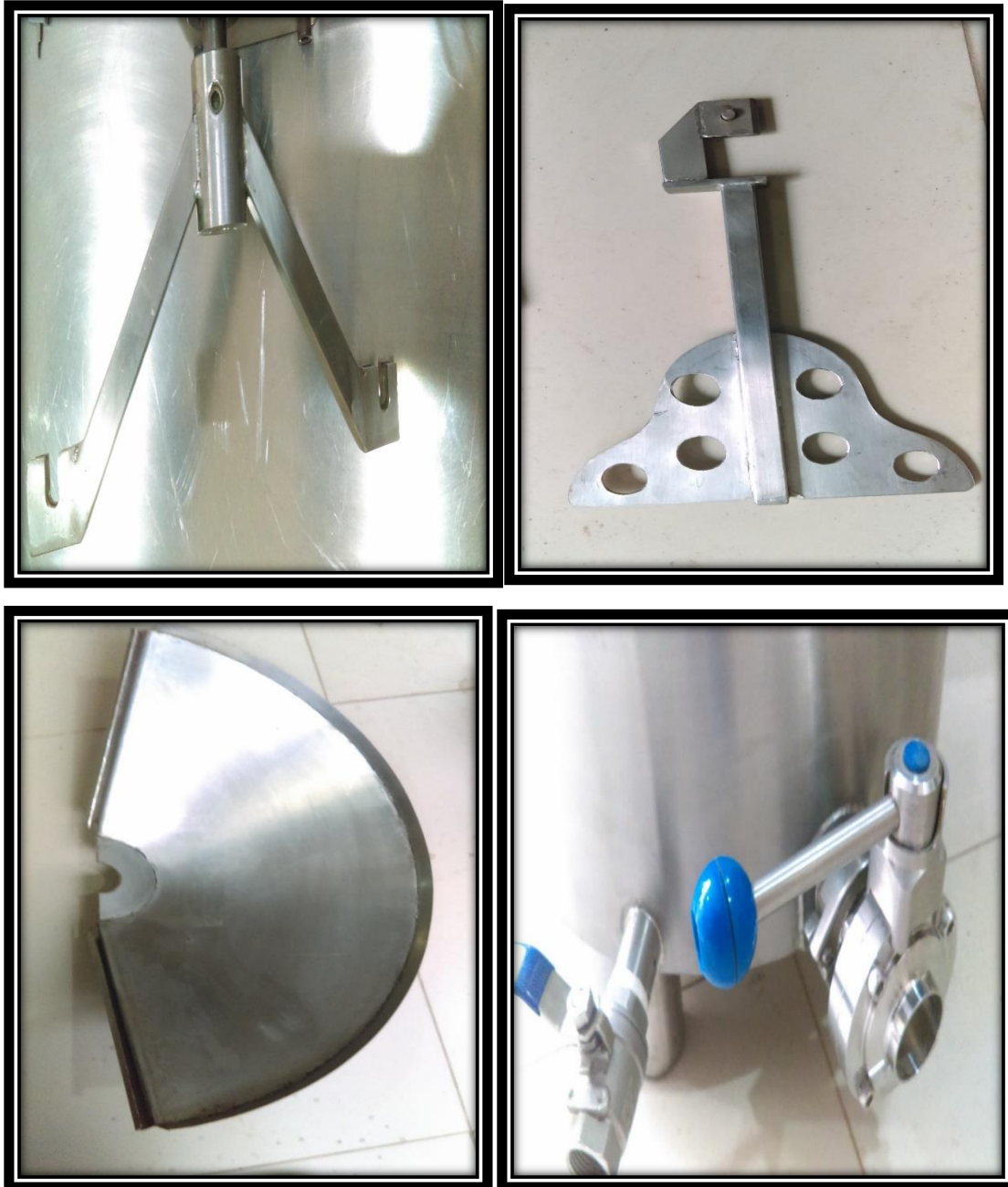
Imagen 9. Partes del sistema de agitación Agitador y tapa de la olla enchaquetada se muestra también la llave de paso sanitaria
