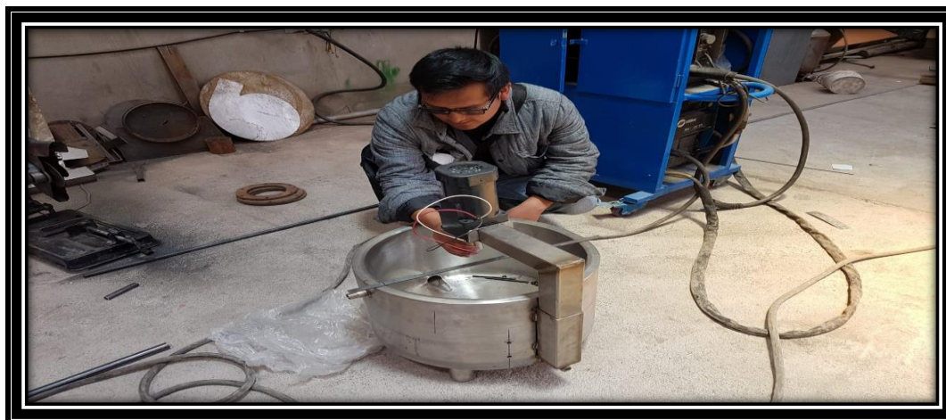
Imagen 02. Proceso de constructivo del equipo de tratamientos térmicos (tanque reactor)
