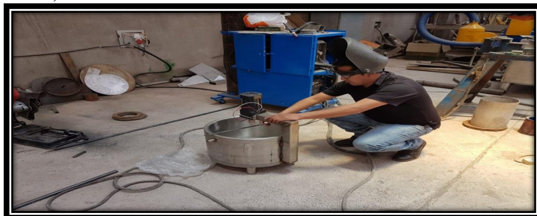
Imagen 02. Proceso de constructivo del equipo de tratamientos térmicos (tanque reactor)
