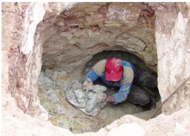
**Figura 5: Excavación artesanal de un yacimiento de arcilla, socavones de 5 a 10 metros de profundidad en la Zona Altiplánica de Azángaro – Puno (3950 m.s.n.m.)**
