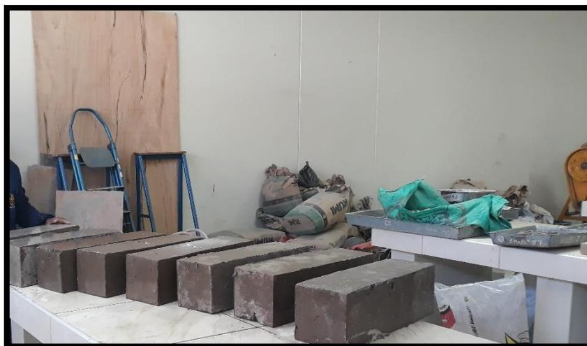
*Figura 15 Elaboración de probetas prismáticas*
