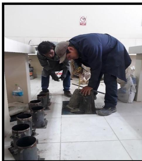
*Figura 14 Elaboración de testigos cilíndricos*
