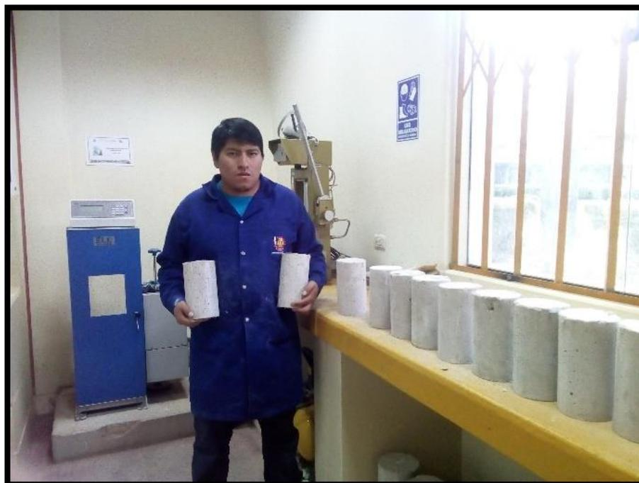
Figura 3 Testigos cilíndricos sometidos a ciclos de congelamiento
