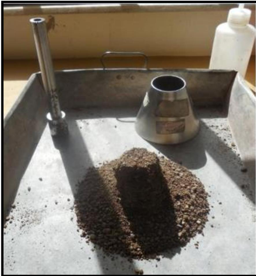
*Figura 8 Desmoronamiento del cono de arena*
