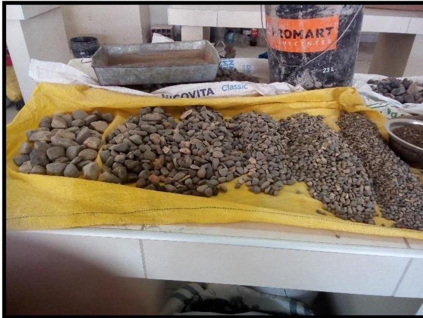
*Figura 11 Granulometría del agregado grueso*
