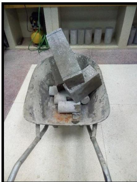
*Figura 28 Testigos prismáticos ya siendo sometidos a la resistencia a la flexión*
