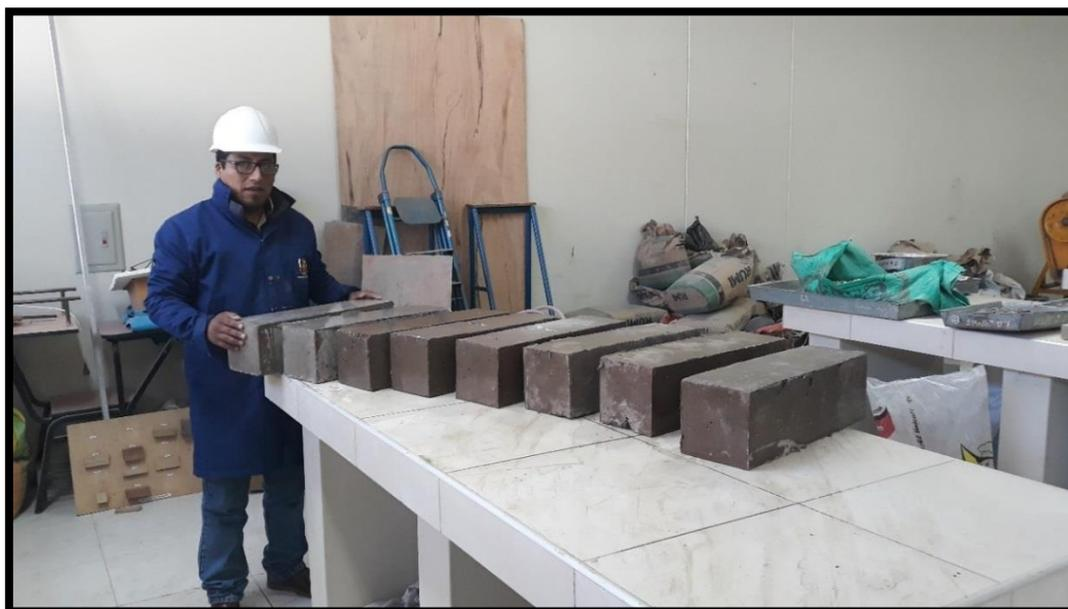
Figura 4 Testigos prismáticos son sometido a ciclos de congelamiento
