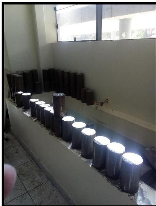
Figura 2 Testigos cilíndricos sin someter a ciclos de congelamiento
