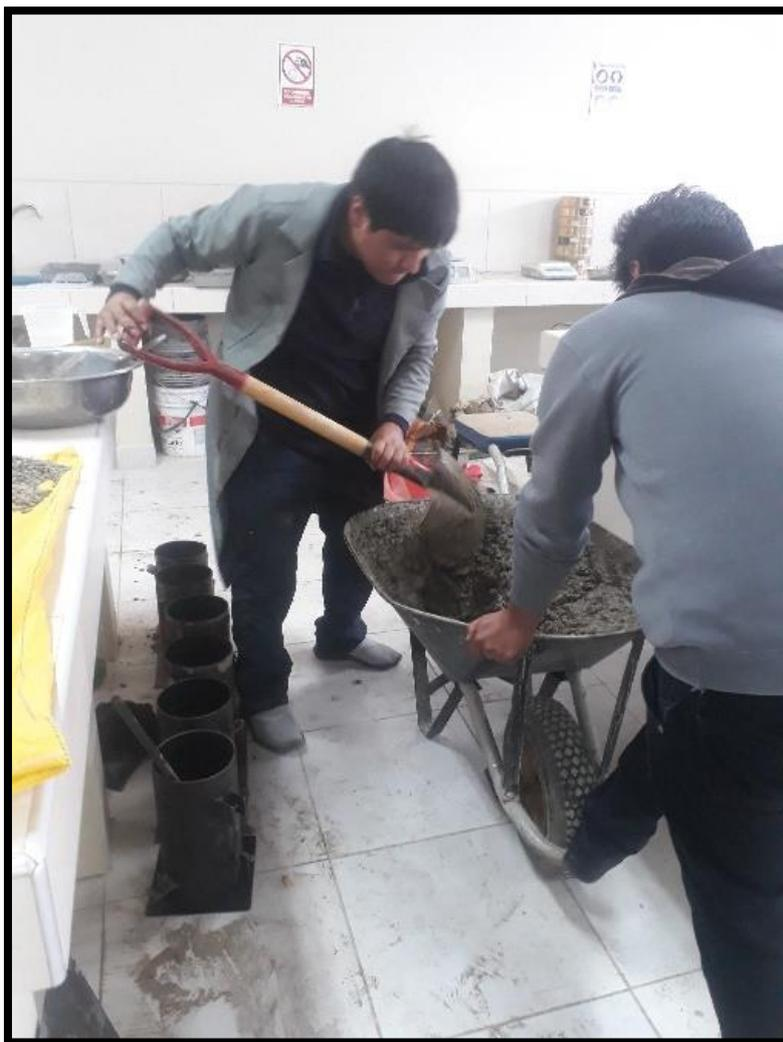
Figura 12 Elaboración del concreto
