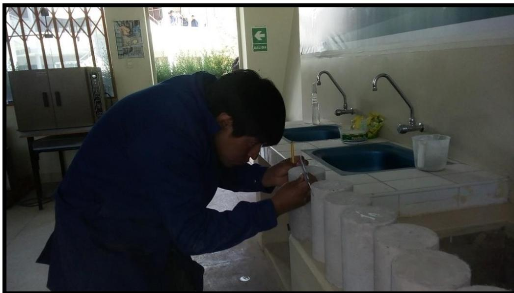
Figura 24 Medición de los diámetros de los testigos cilíndricos
