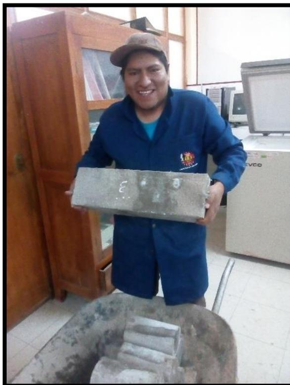
Figura 5 Testigos prismáticos sometido a ciclos de congelamiento
