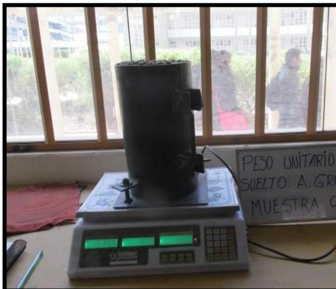
Figura 9 Peso unitario suelto del agregado grueso
