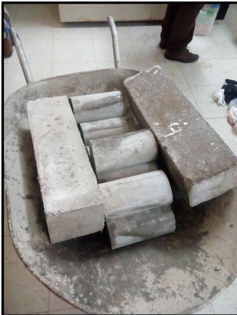
*Figura 20 Testigos cilíndricos y prismáticos sometidos a ciclos de congelamiento*
