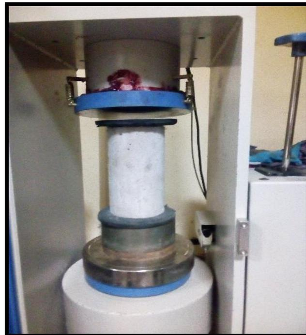
Figura 23 Testigos cilíndricos sometidos a la resistencia a la compresión
