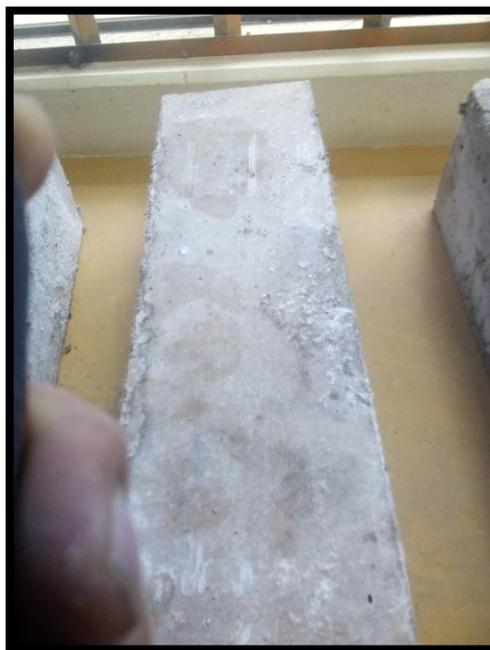
Figura 21 Testigo prismático sometido a ciclos de congelamiento, listos para sometidos a resistencia a la flexión
