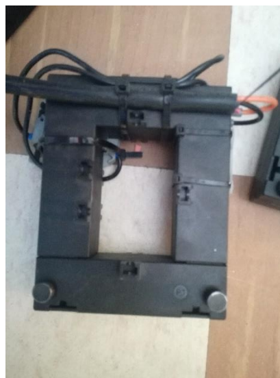
FOTO 06.- Transformador de Corriente CIRCUTOR modelo TP-58 500/5A.
