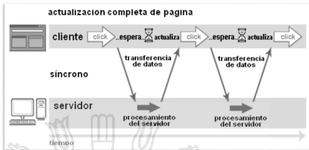
Figura 1. Modelo Tradicional de una Aplicación Web
