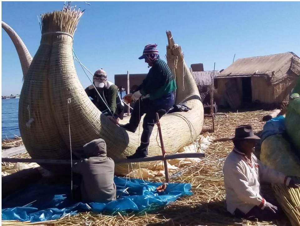
Construcción de una balsa de totora.
