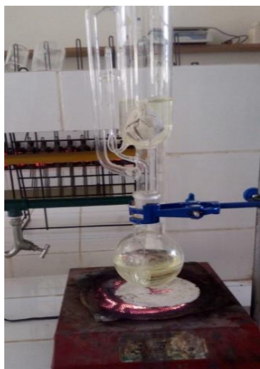
Desengrasado de la harina de quinua en el equipo soxhlet
