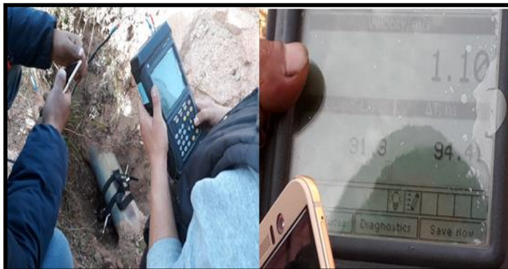
**Figura 49:** Prueba de medición del Caudalímetro Ultrasónico línea 8”.
