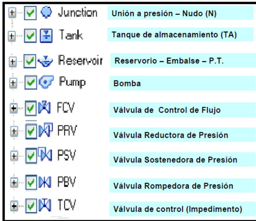
*Figura 30: Prototipos y Elementos del Watercad v8i.
