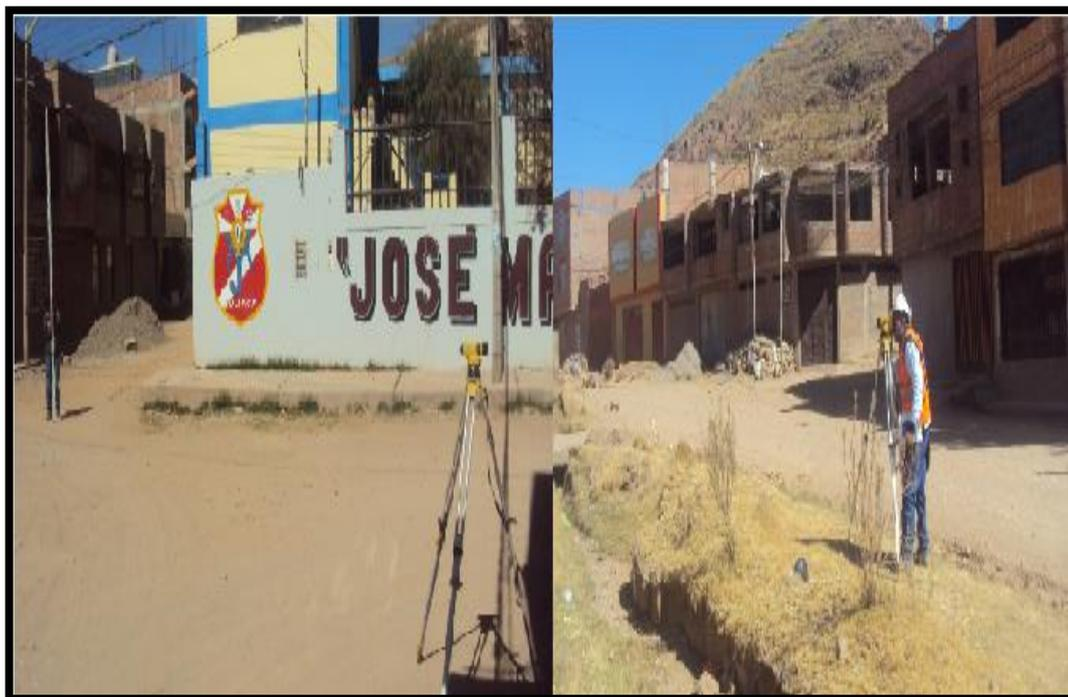
*Figura 39: Fotografías del levantamiento de nivelación compuesta de las redes secundarias.*
