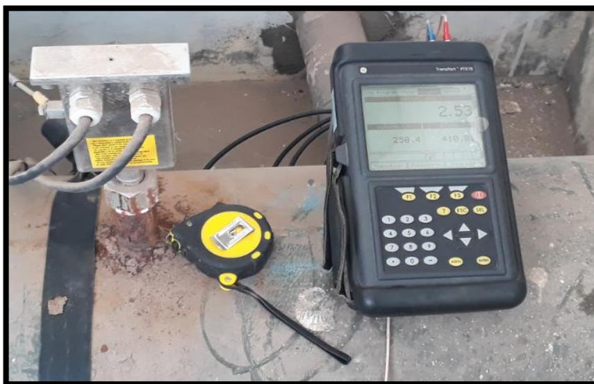
*Figura 16: Caudalímetro ultrasónico.*
