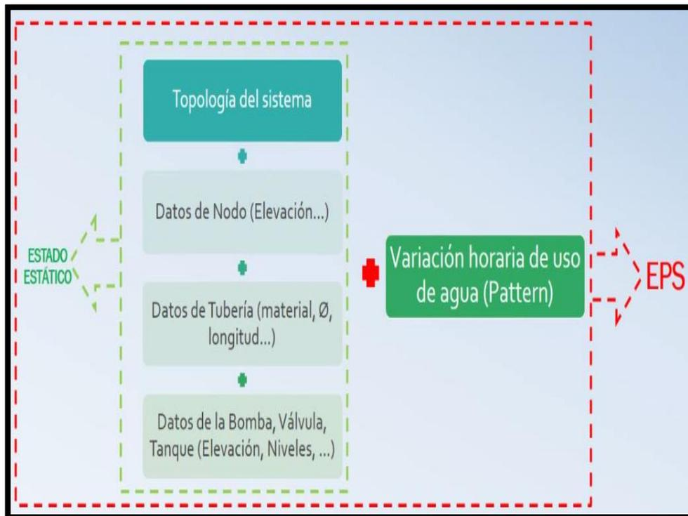
**Figura 31:** Realización de la simulación en periodo extendido EPS.
