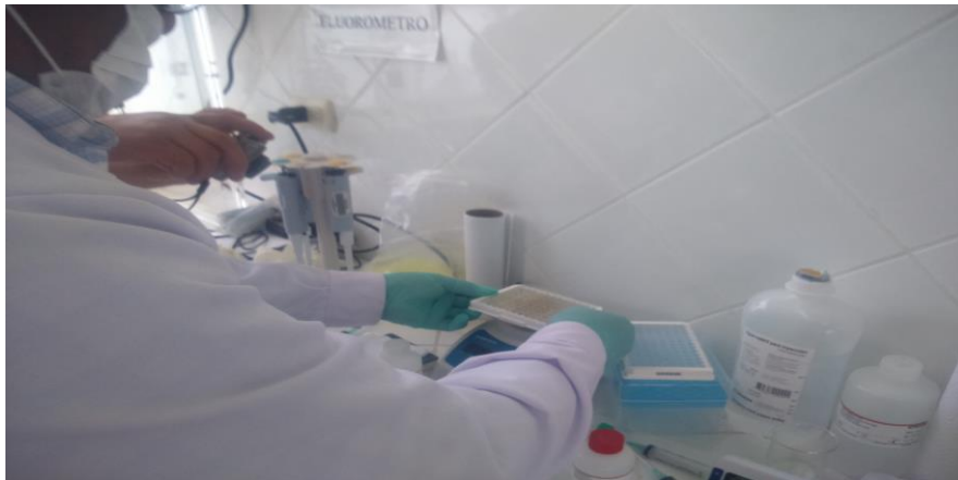
FIGURA A 10. MEZCLAR EL CONTENIDO DE LOS POCILLOS
