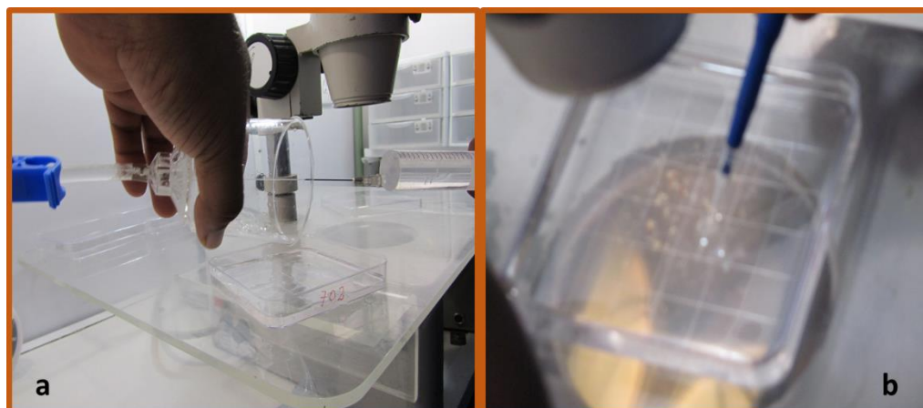
Figura 10: Vaciado y enjuague del filtro a la placa Petri cuadrículada (a), búsqueda de los embriones en la placa Petri cuadrículada (b).
