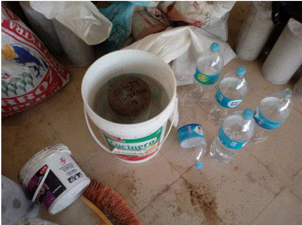
Foto 03: Proceso de curado del concreto con agregado minero
