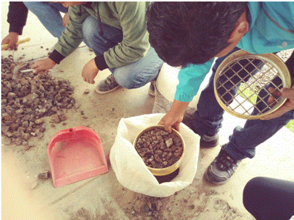
Foto 02: Proceso de triturado para obtención de agregado de residuo minero
