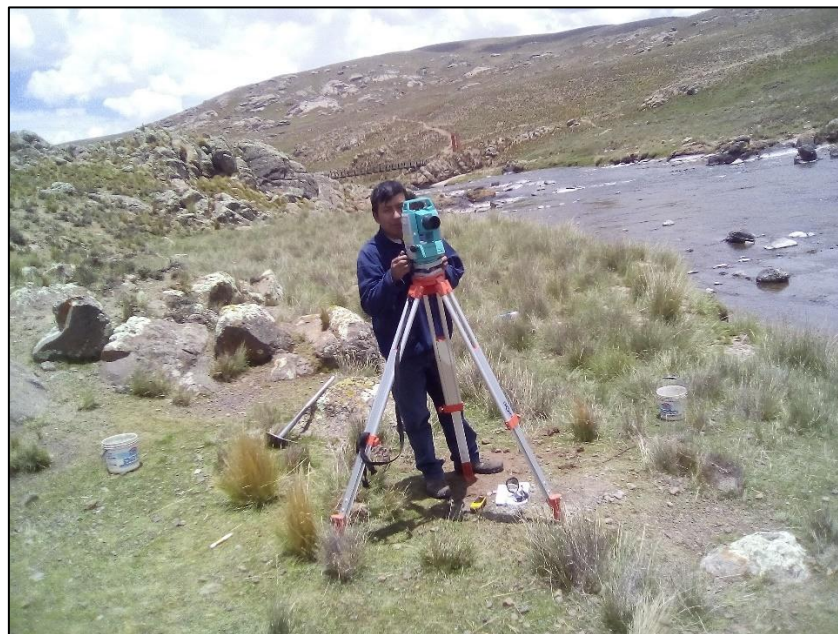
Figura 39: Levantamiento Topográfico con estación total. Fuente: (Elaboración propia).
