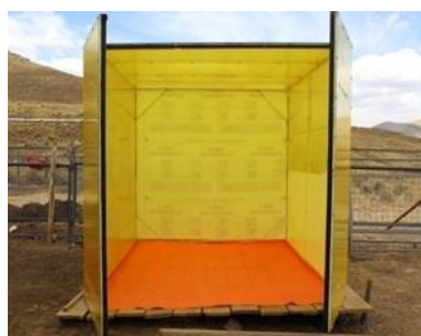
Figura 5. Cámara de acumulación de gases, CIP La Raya 2017.
