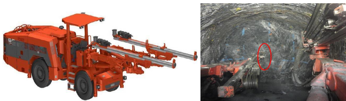
Figura 2.12 Jumbo Sandvik DD32 perforando en Nivel 4100
