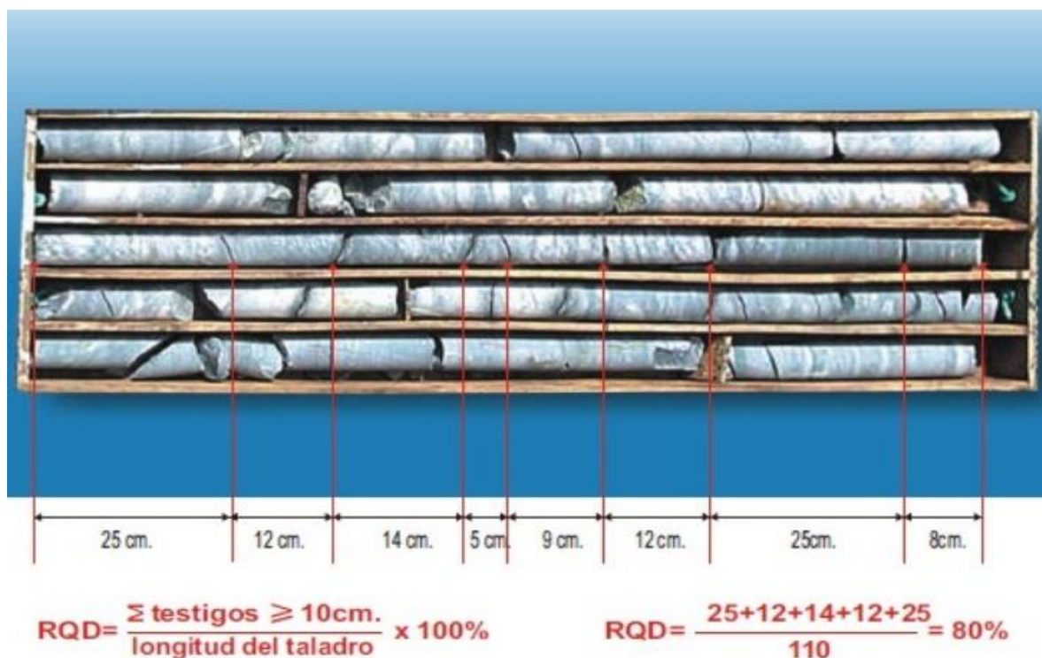
Figura 1.1 Estimación de RQD a partir de testigos de sondeo
