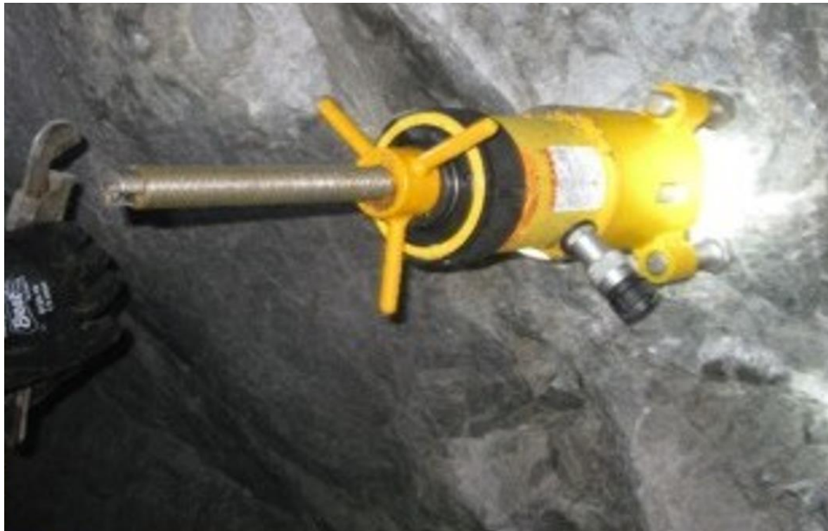
Anexo G3. Equipo de pull test. Fuente. Área geomecánica-Unidad San Cristóbal
