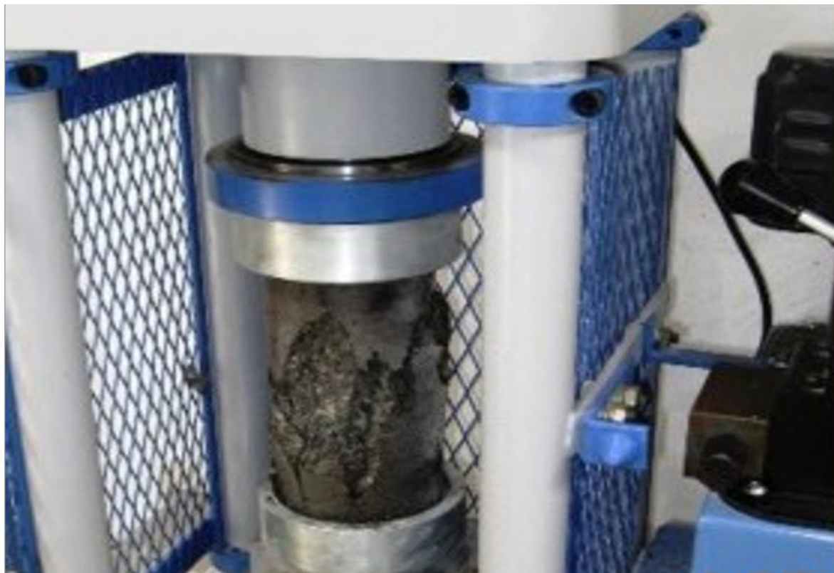
Anexo G4. Equipo de compresión simple. Fuente. Área eomecánica-Unidad San Cristóbal.
