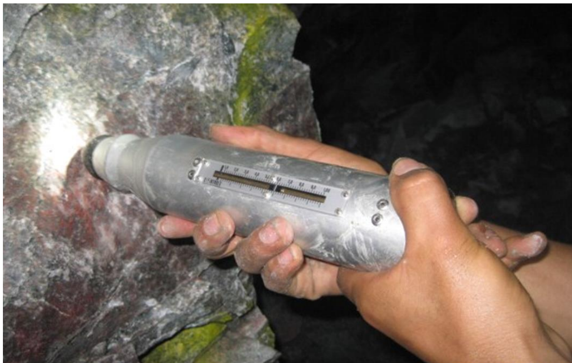
Anexo G2. Esclerómetro – Martillo Schmidt Fuente. Área geomecánica-Unidad San Cristóbal.
