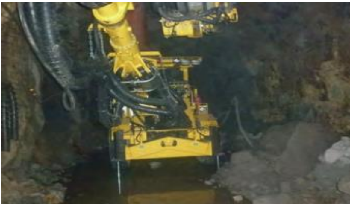
Anexo A4 Jumbo electro hidráulico Boomer de 1 brazo.
