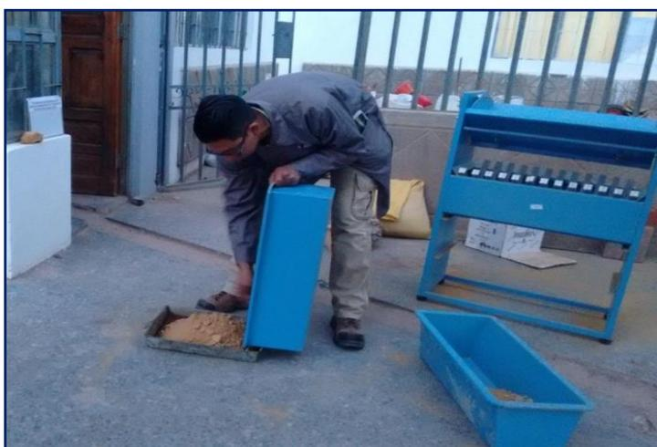
*Figura 3.28: Elección de la porción más representativa de muestra cuarteada, para posteriormente lavar la muestra elegida.*
