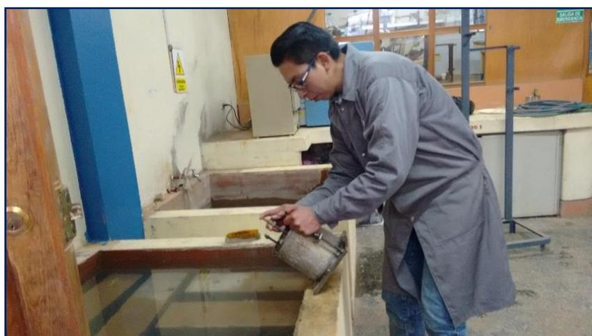
**Figura 3.88:** Ecurrimiento de moldes CBR después de 4 días de sumergidos.
