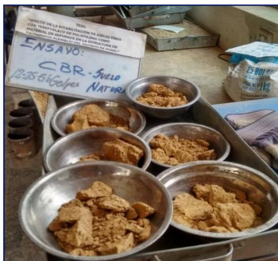
**Figura 3.86:** Muestras secas obtenidas del ensayo de CBR para control de humedad.
