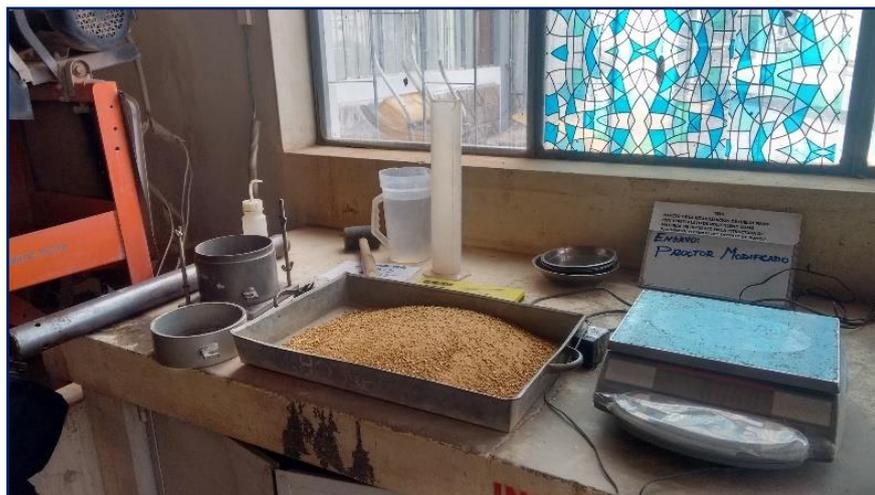
**Figura 3.46: Materiales y equipos utilizados en el ensayo Proctor modificado.**
