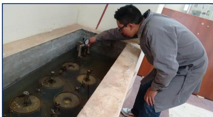
**Figura 3.114:** Lectura con deformímetro cada 24 horas de muestras compactadas.
