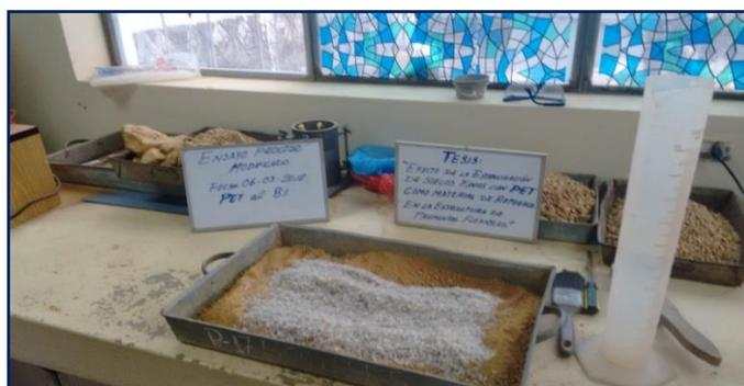
**Figura 3.65: PET al 8% y agua al 13% del peso seco del suelo.**
