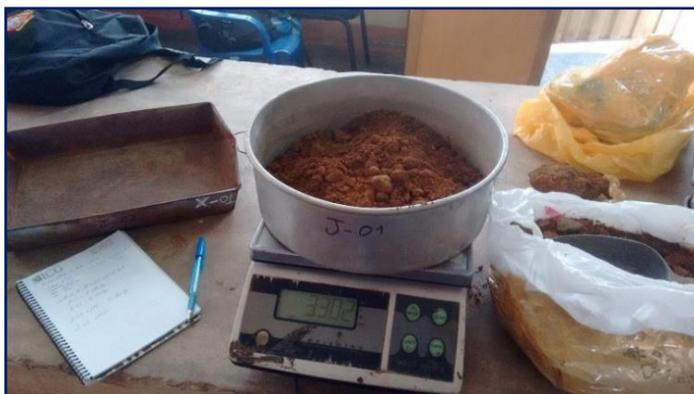
**Figura 3.24:** Pesado de muestras de suelo en estado húmedo.
