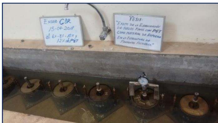
**Figura 3.113:** Primera lectura de la deformación de muestra compactada.
