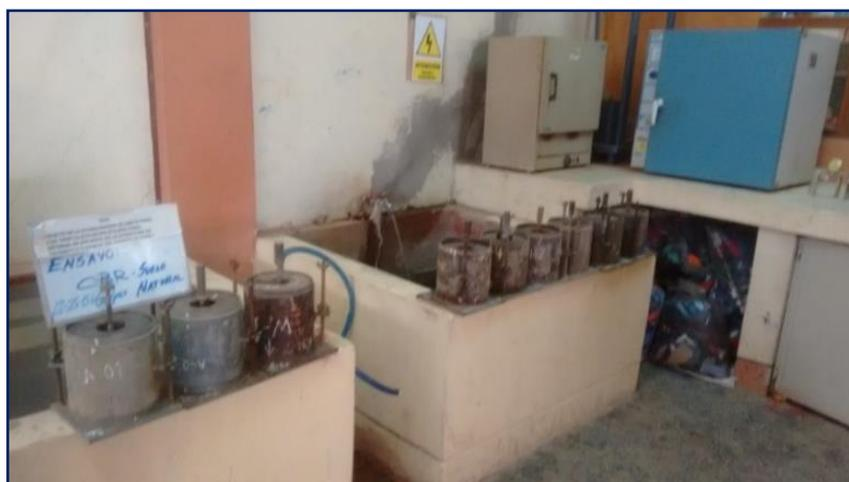
**Figura 3.84:** Sumergido de moldes en agua para control de su deformación durante 4 días.
