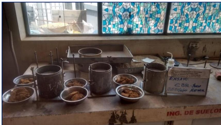
**Figura 3.83:** Moldes CBR a 12, 25 y 56 golpes enraizados, con papel filtro en la base y parte superior del molde como también muestras para controlar la humedad propuesta.
