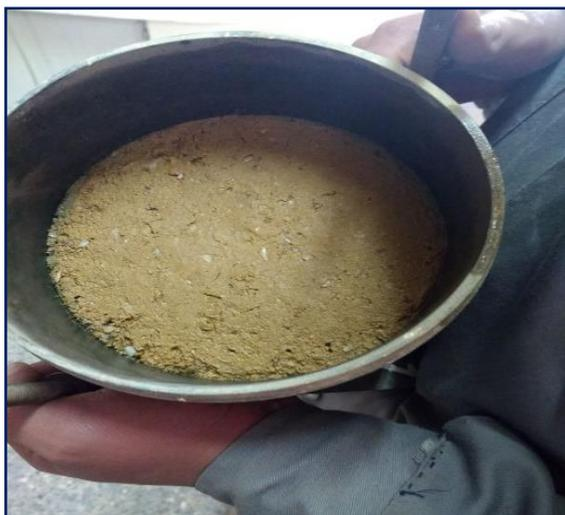
**Figura 3.117:** Superficie de muestra compactada con PET lista para ser ensayada en prensa.
