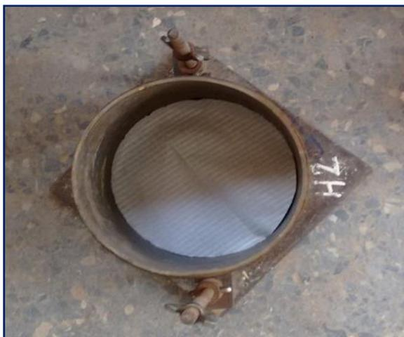
**Figura 3.80:** Molde CBR con disco espaciador y papel filtro en la base.
