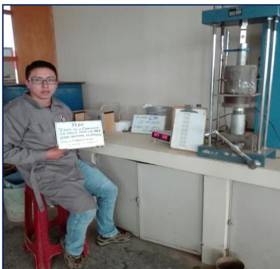
**Figura 3.119:** Muestra y molde CBR en prensa manual de CBR.
