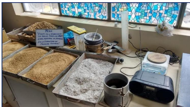
*Figura 3.57: Materiales, equipos e Insumos a utilizar en ensayo Proctor Modificado.*
