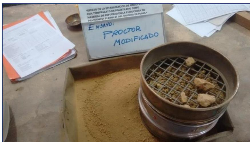
**Figura 3.48: Tamizado de muestra para elección de método de Proctor Modificado a utilizar.**
