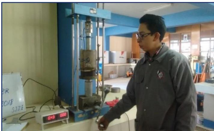
Figura 3.120: Funcionamiento de prensa manual a 1.27 mm/min y registro de esfuerzos.
