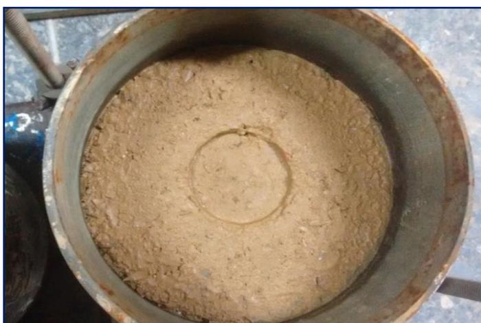
Figura 3.121: Muestra con PET después de ser ensayada en prensa CBR.
