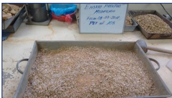
**Figura 3.66: PET al 10% y agua al 13% del peso seco del suelo.**
