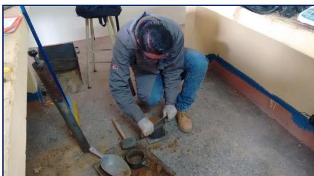
**Figura 3.55:** Enrazado y registro de peso de molde más suelo compactado.
