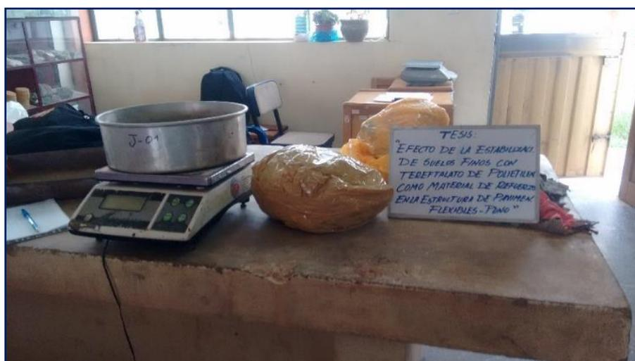
**Figura 3.22:** Muestra de suelo debidamente sellado para evitar pérdida de humedad.
