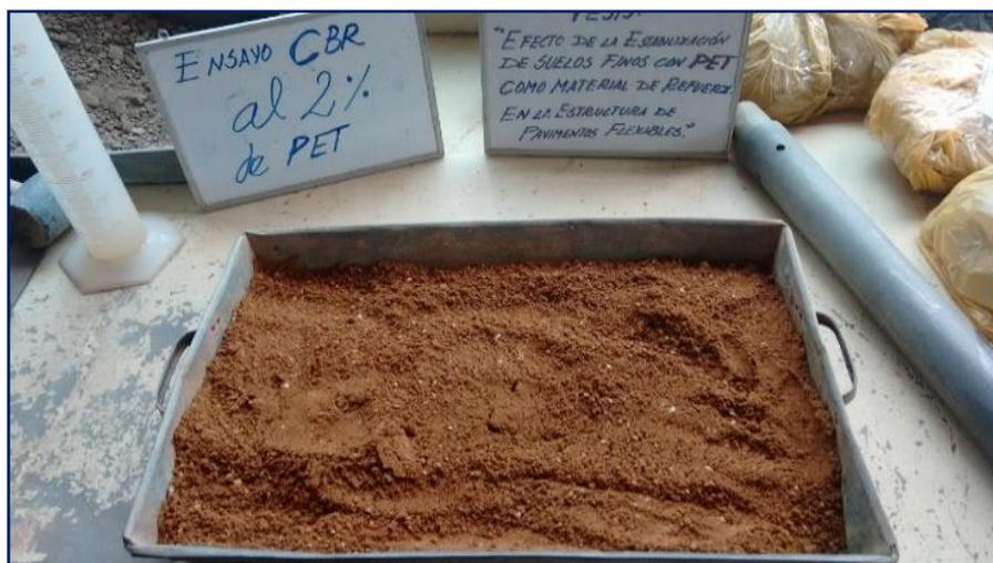
**Figura 3.104:** Suelo, PET al 2% y agua al 14.5% mezclado y homogenizado.
