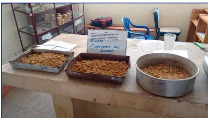
**Figura 3.26:** Pesado y registro de muestras en estado seco, después de 24 horas.
