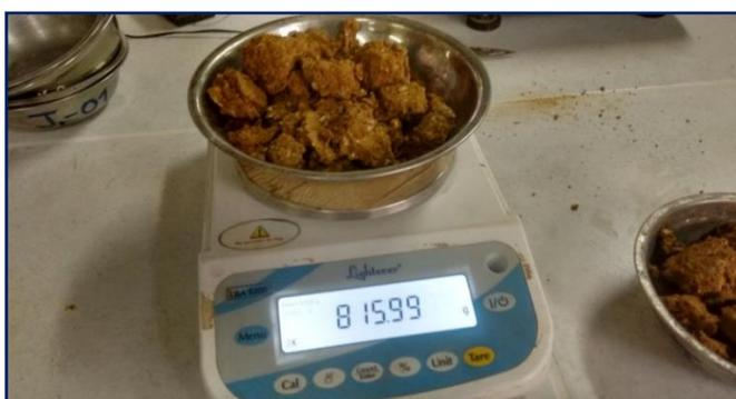
**Figura 3.73:** Extracción de muestra con PET para su pesado y secado en horno eléctrico.
