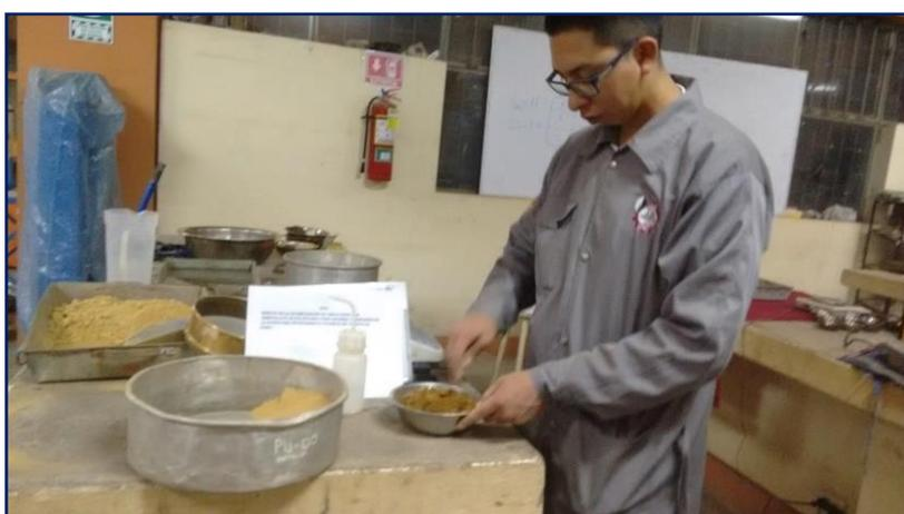
**Figura 3.36:** Saturación durante 24 horas del material tamizado anteriormente.
