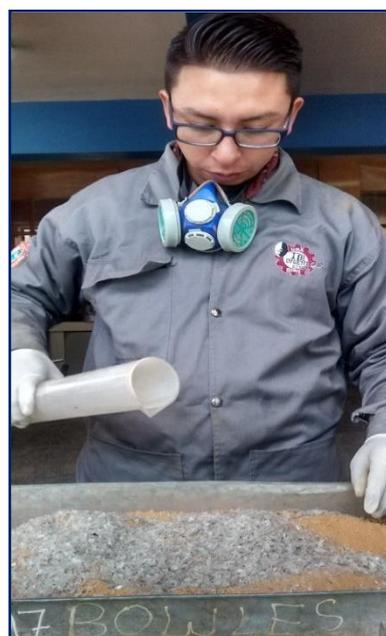
Figura 3.62: Vertimiento de PET y agua para su mezcla con suelo en las proporciones calculadas.
