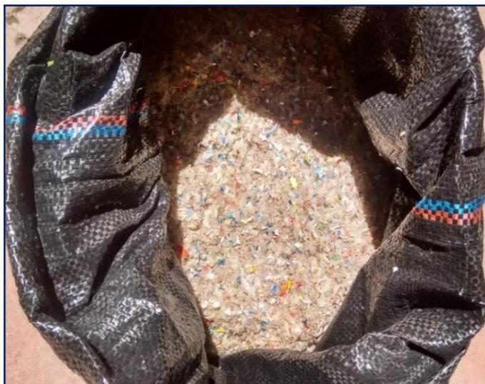
**Figura 3.6:** PET picado en sus condiciones iniciales, elaborado por la empresa RESITEC.
