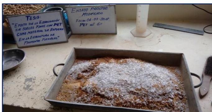
**Figura 3.64: PET al 6% y agua al 13% del peso seco del suelo.**
