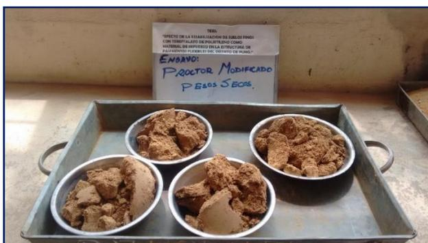
**Figura 3.56:** Muestra compactada y secado en horno eléctrico durante 24 horas a 110°C.
