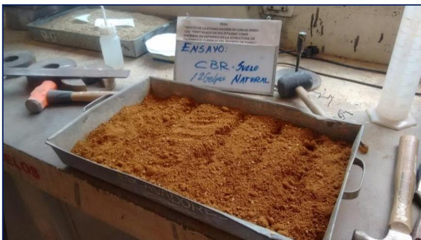
**Figura 3.81:** Muestra preparada con la humedad obtenida en el ensayo de Proctor.
