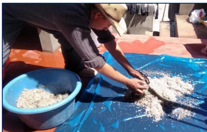
**Figura 3.8:** Escurrimiento y proceso de secado de PET después del lavado.
