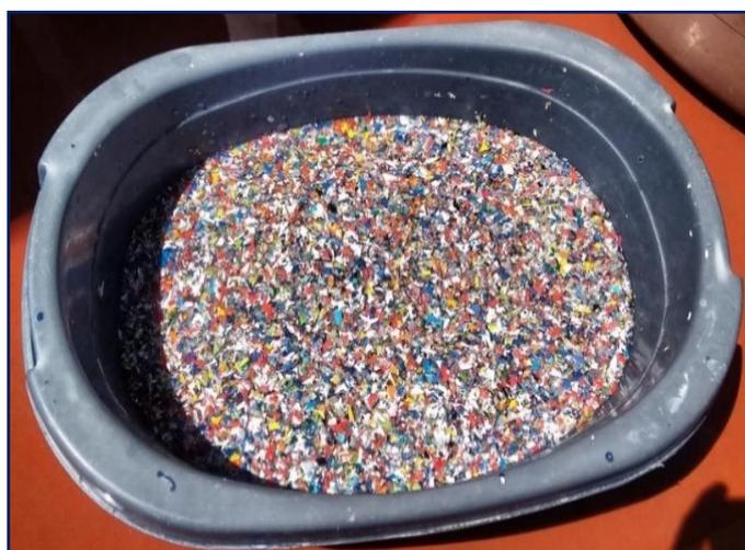
**Figura 3.7:** Lavado de PET, retiro de etiquetas y demás contaminantes del plástico.
