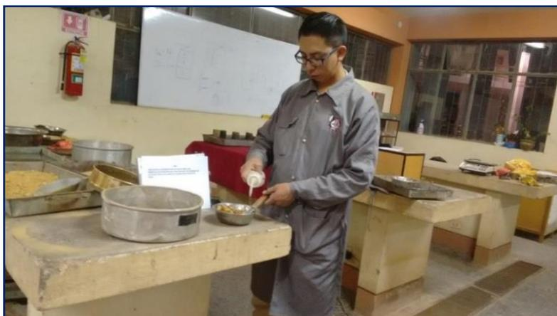
**Figura 3.41:** Tamizado por la malla N°40 y saturado de muestra durante 24 hr.
