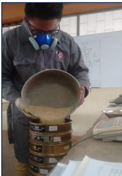
*Figura 3.32: Vertimiento de la muestra en los tamices, agitándolos enérgicamente para permitir la gradación.*
