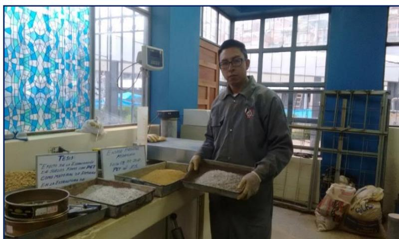
**Figura 3.11:** PET final tamizado pasante malla N°4 y retenido malla N°10.
