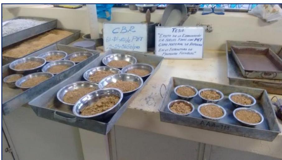
**Figura 3.111: Muestras obtenidas de los moldes CBR para control de su humedad.**
