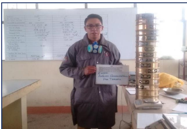
*Figura 3.31: Juego de tamices debidamente ordenados para el ensayo de granulometría.*
