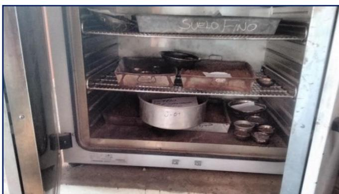
**Figura 3.25:** Secado de muestras húmedas de suelo anteriormente pesadas en horno eléctrico durante 24 horas a  $110\pm 5$  °C.
