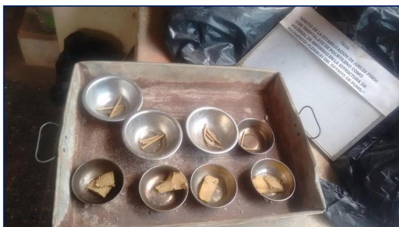
*Figura 3.45: Secado de muestras en horno eléctrico durante 24 horas a 110°C, registrando sus pesos antes y después de su secado.*
