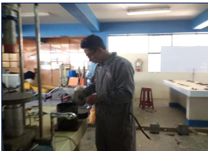
**Figura 3.118:** Colocado de sobrepeso en la superficie de muestra compactada.
