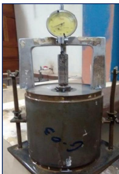
**Figura 3.87:** Medición de la deformación cada 24 horas durante 4 días con deformímetro.
