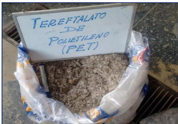
**Figura 3.9:** PET lavado secado y listo para su uso en laboratorio.
