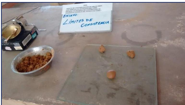
**Figura 3.42:** Porciones de muestra para formar rollitos del diámetro de la mina de lapicero aproximadamente.
