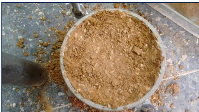
**Figura 3.70:** Muestra con PET compactada a 56 golpes cada capa.
