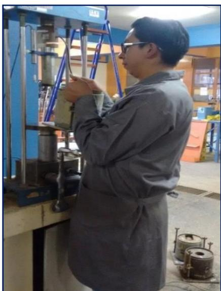
**Figura 3.90: Colocado de molde CBR en prensa.**
