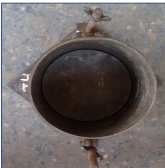
**Figura 3.79:** *Molde CBR con disco espaciador en su base.*
