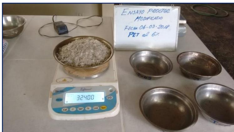
*Figura 3.59: Dosificación de PET (6% del peso seco de la muestra) del mismo modo para los demás porcentajes.*
