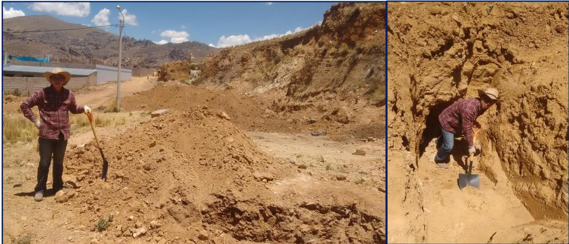
**Figura 3.15: Muestreo de Cantera Salcedo a 1.70m de profundidad.**
