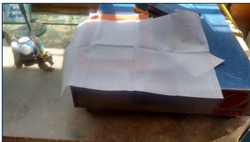
**Figura 3.76: Papel filtro que se utiliza para cubrir la base y la superficie de la muestra dentro del molde.**
