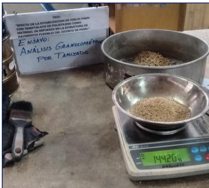
*Figura 3.33: Pesado y registro de las porciones retenidas en cada tamiz.*
