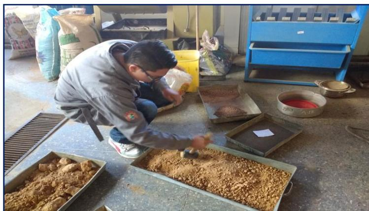
*Figura 3.96: Disgregación de material de cantera.*
