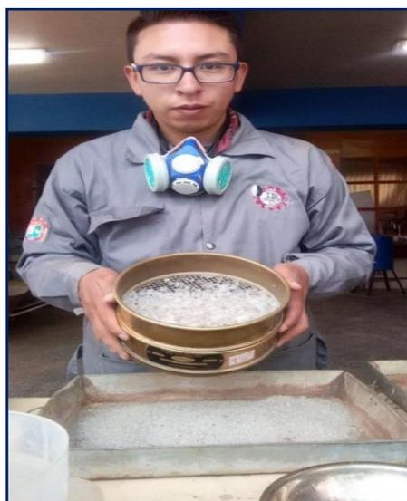
**Figura 3.10:** Tamizado del PET por la malla N°4 y N°10.
