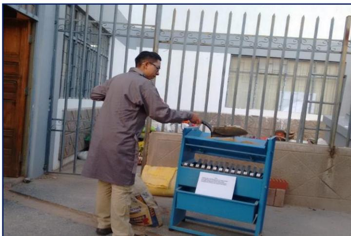
*Figura 3.27: Cuarteo de muestra mediante cuarteador mecánico.*
