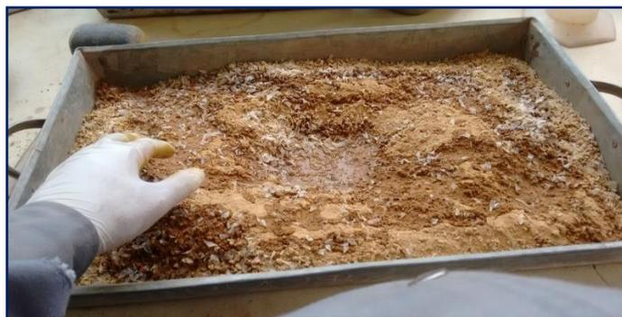
**Figura 3.63: Homogenización de mezcla de suelo, PET y agua.**
