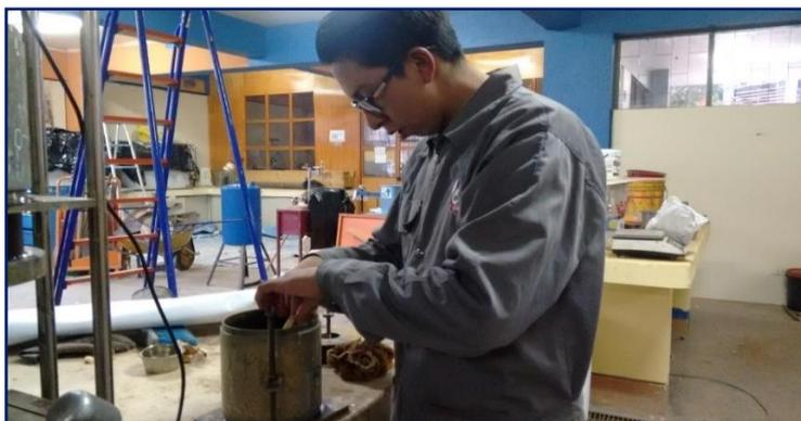
**Figura 3.89: Retiro de papel filtro para proceder a prueba en prensa manual para CBR.**
