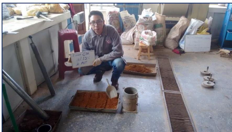
**Figura 3.106:** Muestra dividida en 5 capas expedita para compactación a 12, 25 y 56 golpes.
