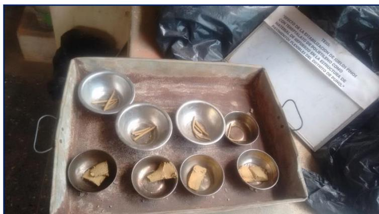
**Figura 3.40:** Secado de muestras en horno eléctrico durante 24 horas a 110°C, registrando sus pesos antes y después de su secado.
