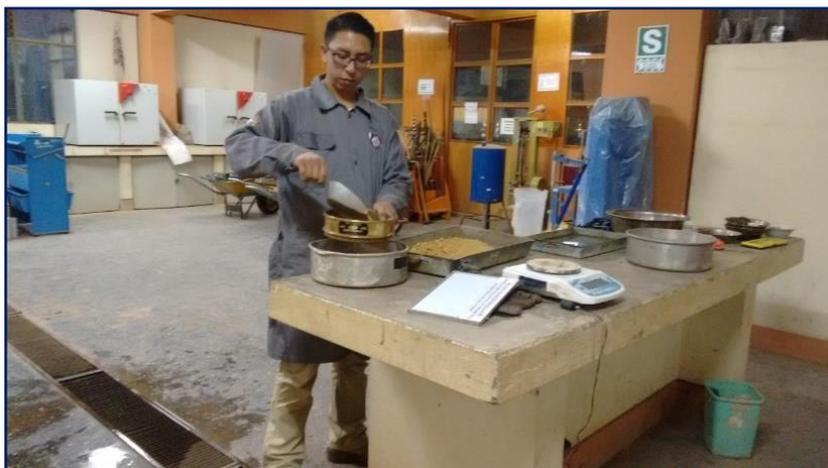
**Figura 3.35:** Tamizado por la malla N° 40 aproximadamente 250 gramos de muestra disgregada y seca.
