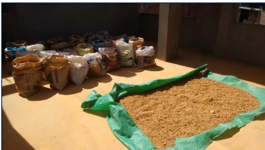
*Figura 3.21: Secado de material de cantera para pruebas de laboratorio.*
