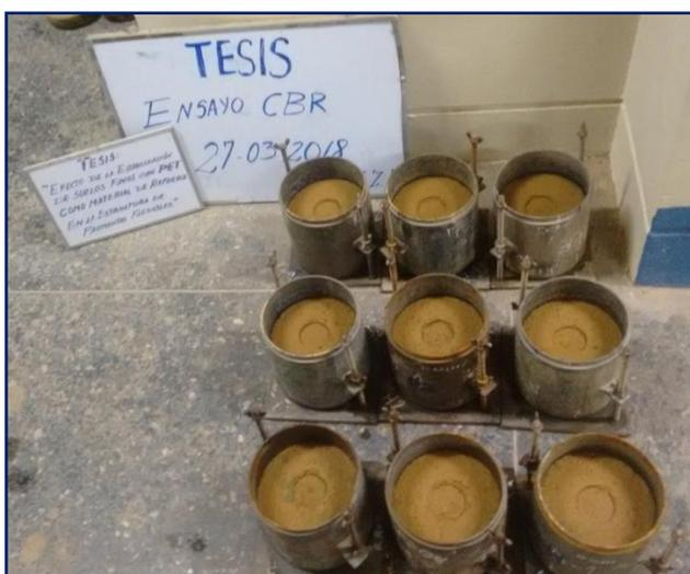
**Figura 3.94:** Moldes CBR ensayados con suelo en condiciones naturales, después de penetración a 1.27mm/min.
