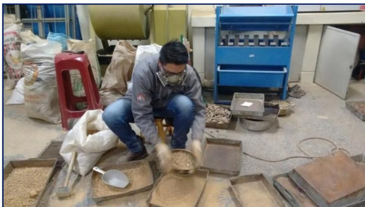
**Figura 3.77:** *Disgregación y tamizado de material para su uso en el ensayo de CBR.*
