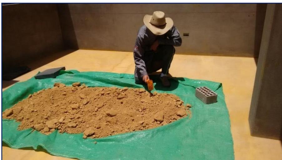
*Figura 3.20: Disgregación de material de cantera con comba de goma.*
