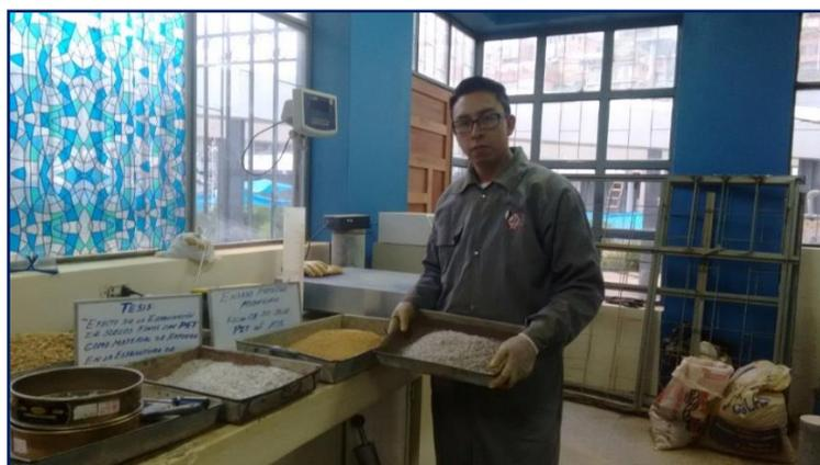
*Figura 3.58: Tereftalato de Polietileno lavado, secado y tamizado.*
