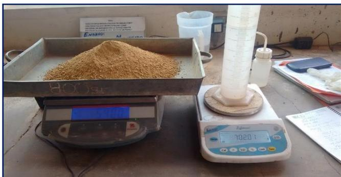
**Figura 3.50:** Dosificación de material seleccionado y agua para cada punto del ensayo.
