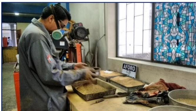
**Figura 3.49:** Tamizado de muestra después de elección de método. (5400 gr/punto aprox.)
