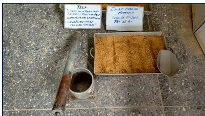
**Figura 3.68:** Muestra separada en 5 capas para su compactación.
