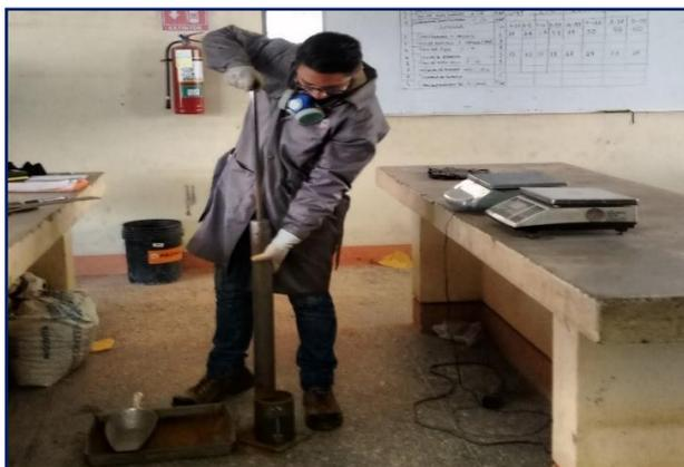
**Figura 3.53:** Pisón de 44.5 N, produciendo energía de compactación de 2700 kN-m/m<sup>3</sup>.
