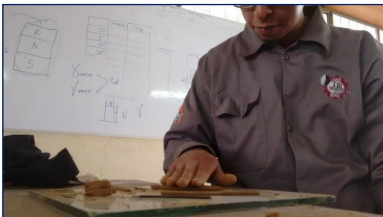
**Figura 3.43:** Formación de rollitos de material seleccionado antes de su fractura.
