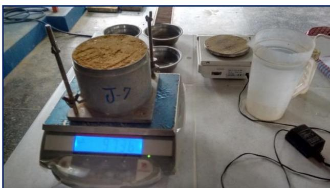
**Figura 3.72:** Pesado y registro de muestra con PET compactada.
