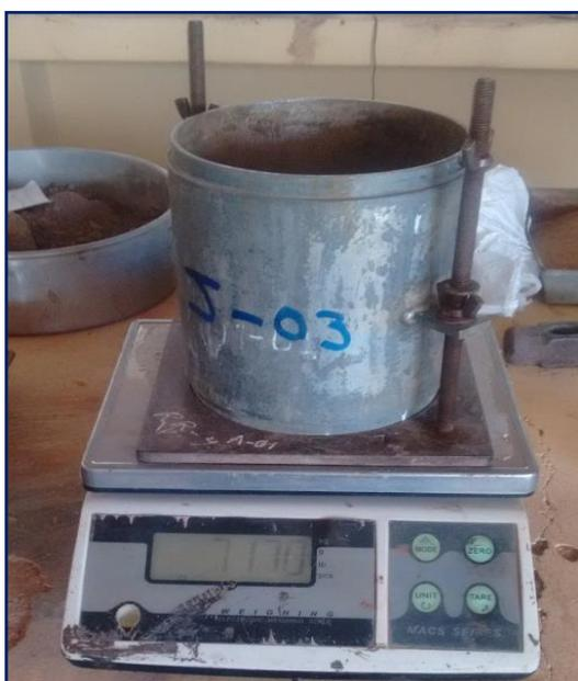
**Figura 3.78:** *Medición del diámetro, altura y peso de los moldes de CBR.*
