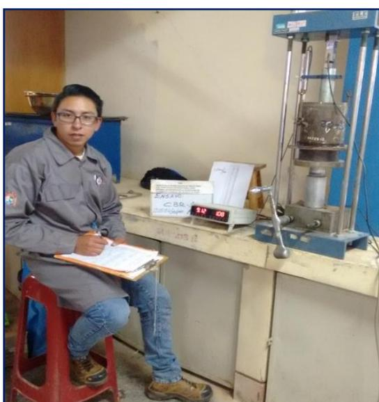
**Figura 3.93:** Registro de los esfuerzos a determinada deformación propuesto según norma.
