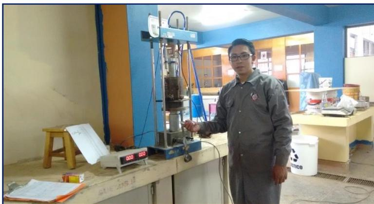
**Figura 3.92:** Inicio de ensayo CBR, giro del mango de la prensa a razón de 1.27 mm/min.
