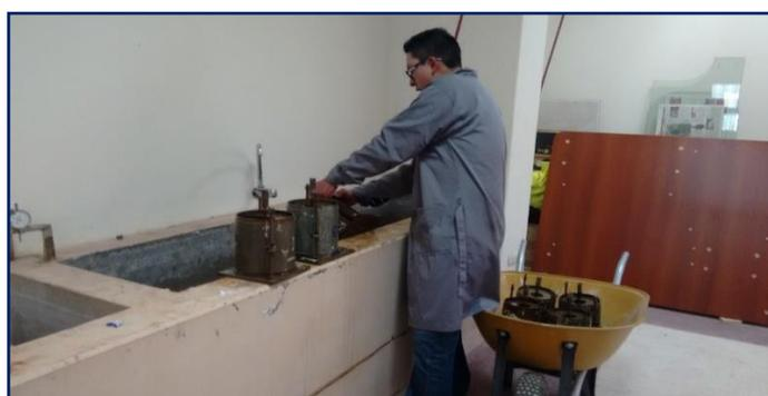
**Figura 3.115:** Retiro de muestras después de 4 días de estar sumergidas.
