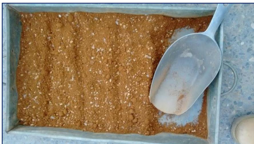
**Figura 3.105:** Suelo, PET al 6% y agua al 14.5% mezclado y homogenizado.
