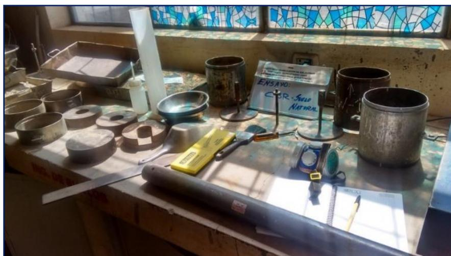
**Figura 3.75: Materiales y equipos utilizados en el ensayo de CBR.**
