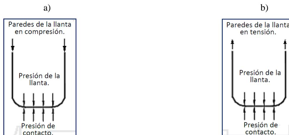
**Figura 2.12: Relación entre la presión de contacto y la presión de la llanta. (a) Baja presión; (b) Alta presión.**
