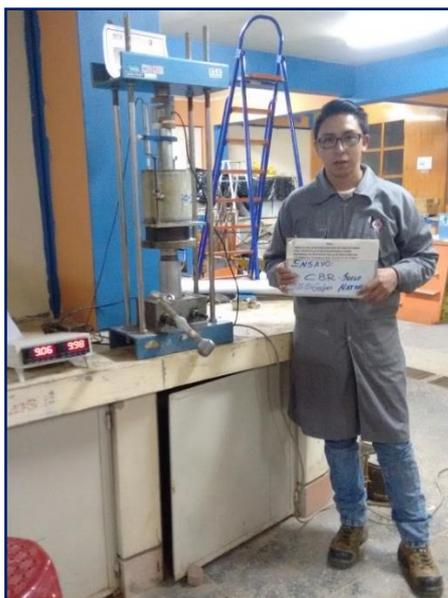
**Figura 3.91: Penetración a molde CBR de 12, 25 y 56 golpes en prensa CBR.**
