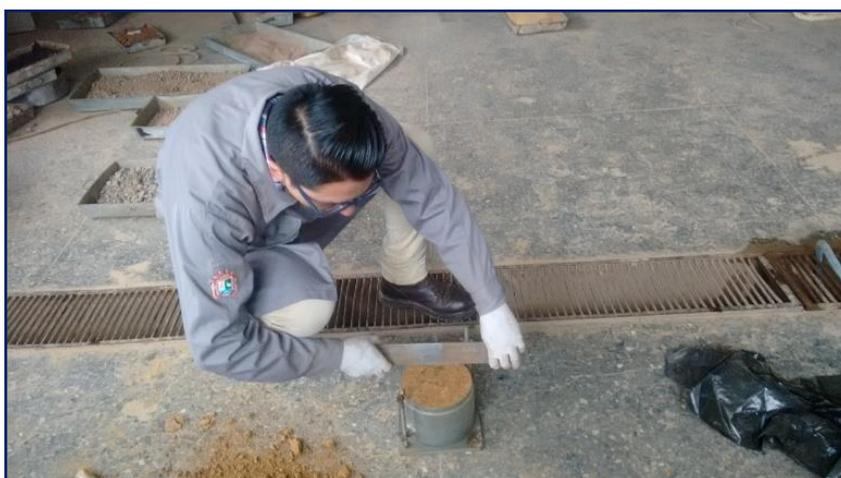
**Figura 3.108:** Enrazado con regla metálica una vez terminado la compactación.
