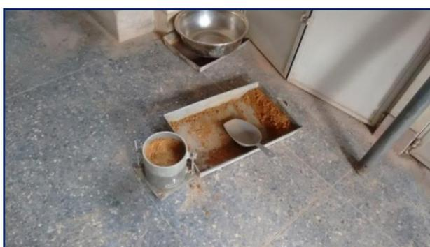
**Figura 3.54:** Compactación de muestra distribuida en 5 capas.
