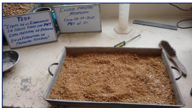
**Figura 3.67:** Suelo, PET y agua debidamente mezclados y homogenizados.
