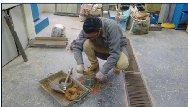
**Figura 3.71:** Enrazado de muestra para su pesado.
