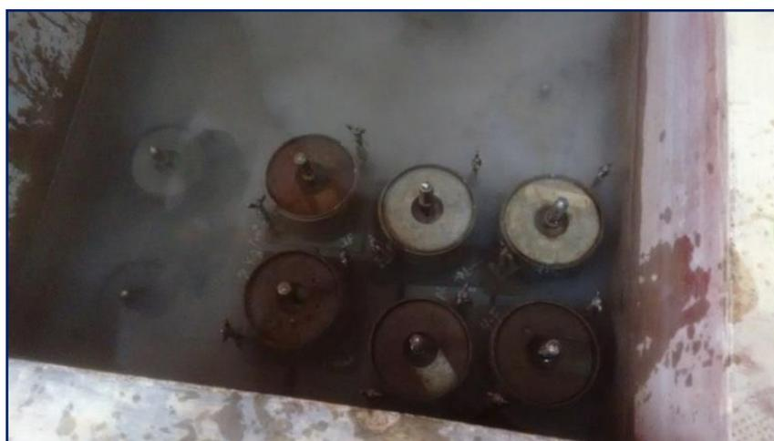
**Figura 3.85:** Moldes CBR sumergidos con sus respectivas pesas y vástagos.
