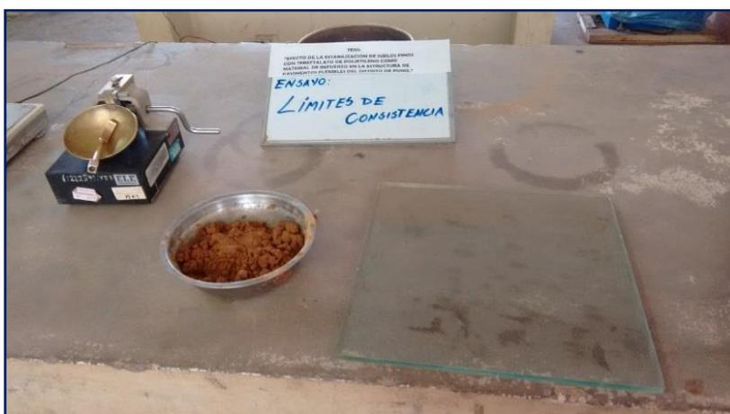
**Figura 3.37:** Muestra saturada y expedita para realizar el ensayo de límite líquido.
