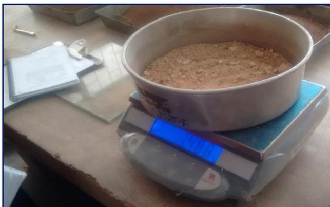
*Figura 3.30: Secado de la muestra durante 18 horas en horno eléctrico a 110°C después de su lavado, pesando y registrando ese dato antes del tamizado.*
