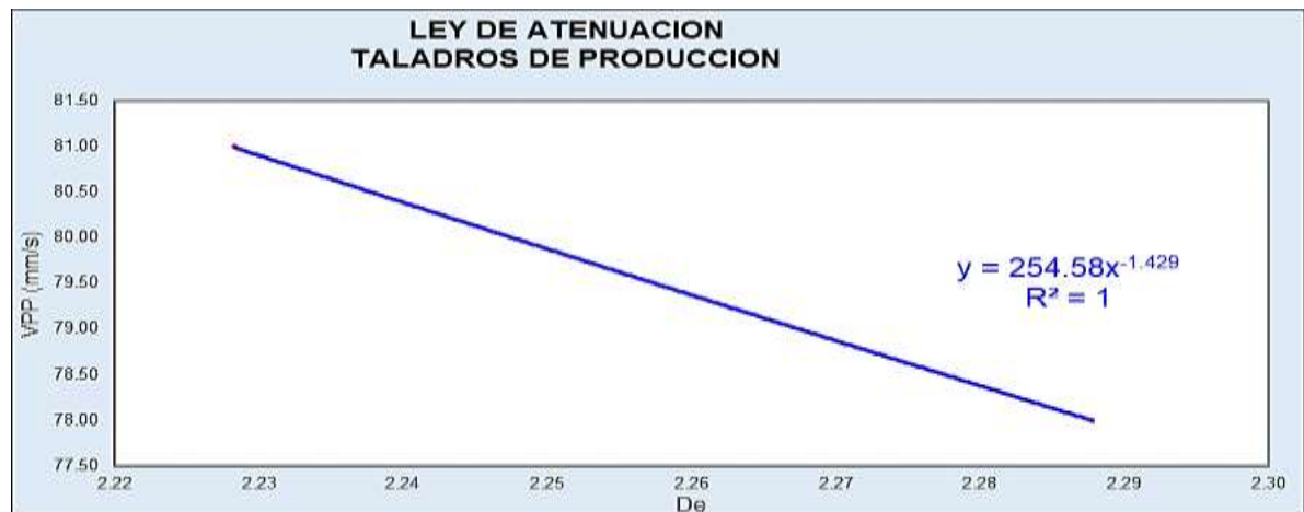
Figura 30. Estimación de la ley de atenuación a partir de los registros tomados en campo para taladros de producción.
