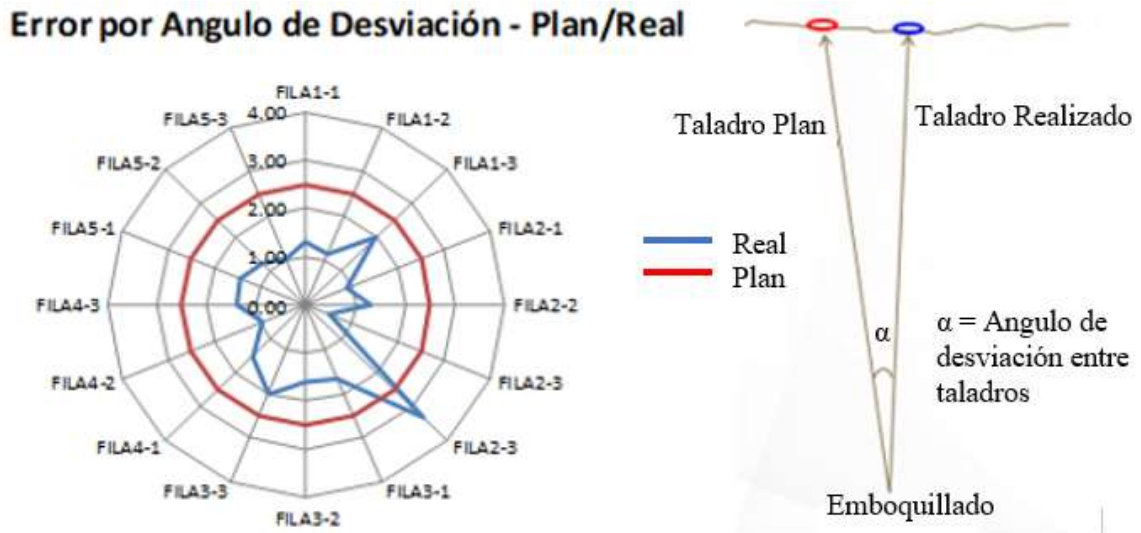
Figura 25. Calculo de la desviación del taladro en plan y real. Fuente: Unidad operativa Inmaculada.
