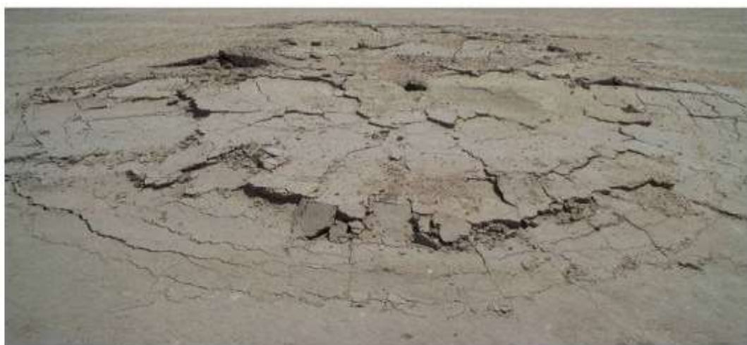
Figura 4. Zona de cráter y zona inelástica. Fuente. Rospigliosi 2009.
