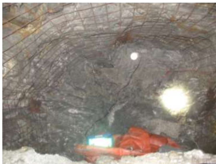
Figura 15. Geófono Ubicado en refugio de la caja techo. Fuente: Autor de tesis.
