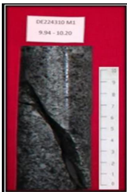
Figura 3.2. Resultado después de la aplicación de esfuerzos en laboratorio FUENTE: Elaboración propia
