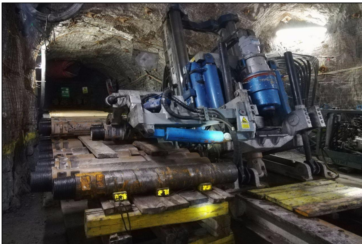
Figura N° 4. Máquina Raise Borer - SBM 700 en Unidad San Rafael MINSUR S.A. FUENTE: Elaboración propia
