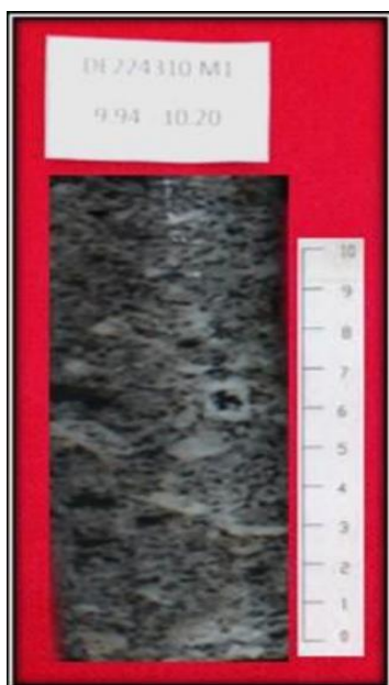
Figura 3.1. La muestra de testigo antes de la aplicación de esfuerzos en laboratorio FUENTE: Elaboración propia
