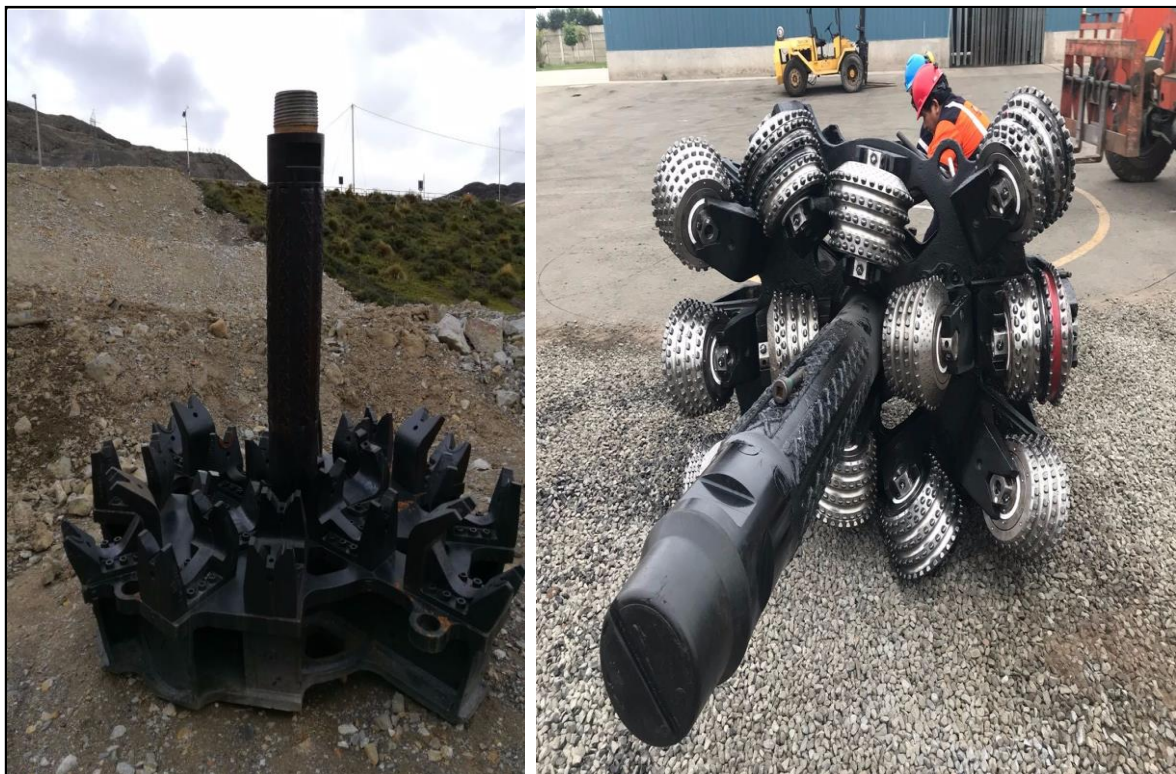
Figura N° 8. Cabeza rimadora de la máquina Raise Borer FUENTE: Elaboración propia
