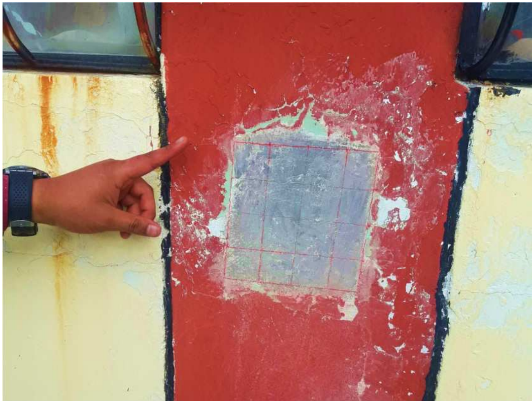
Figura 3.25 Preparación del área de ensayo Fuente: Elaboración propia
