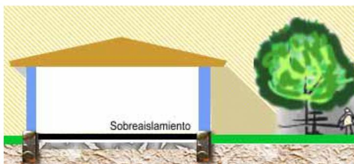
Figura 18: Esquema de diseño bioclimático - sistema pasivo de calentamiento - Sobre aislamiento.
