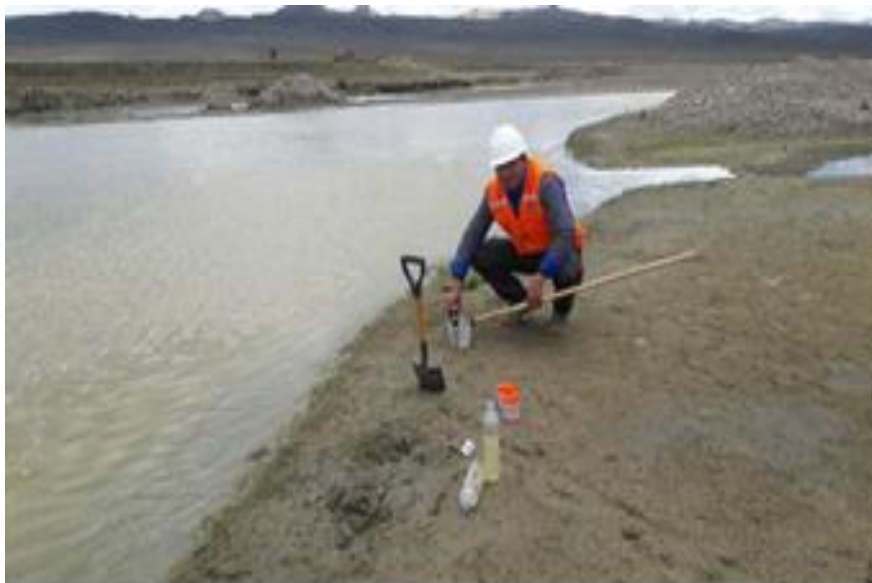
Figura N° 09: Medición de Conductividad, pH, T° - PM - N°01. Fuente: Fotografía tomada en el campo.
