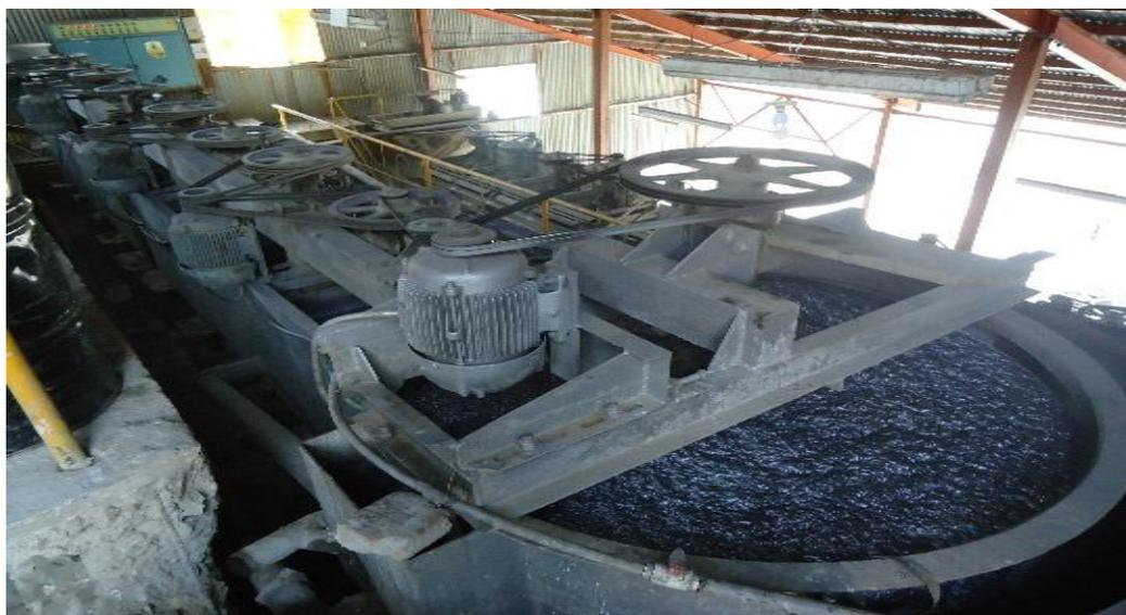
**Figura 5.** Celdas de Flotación
