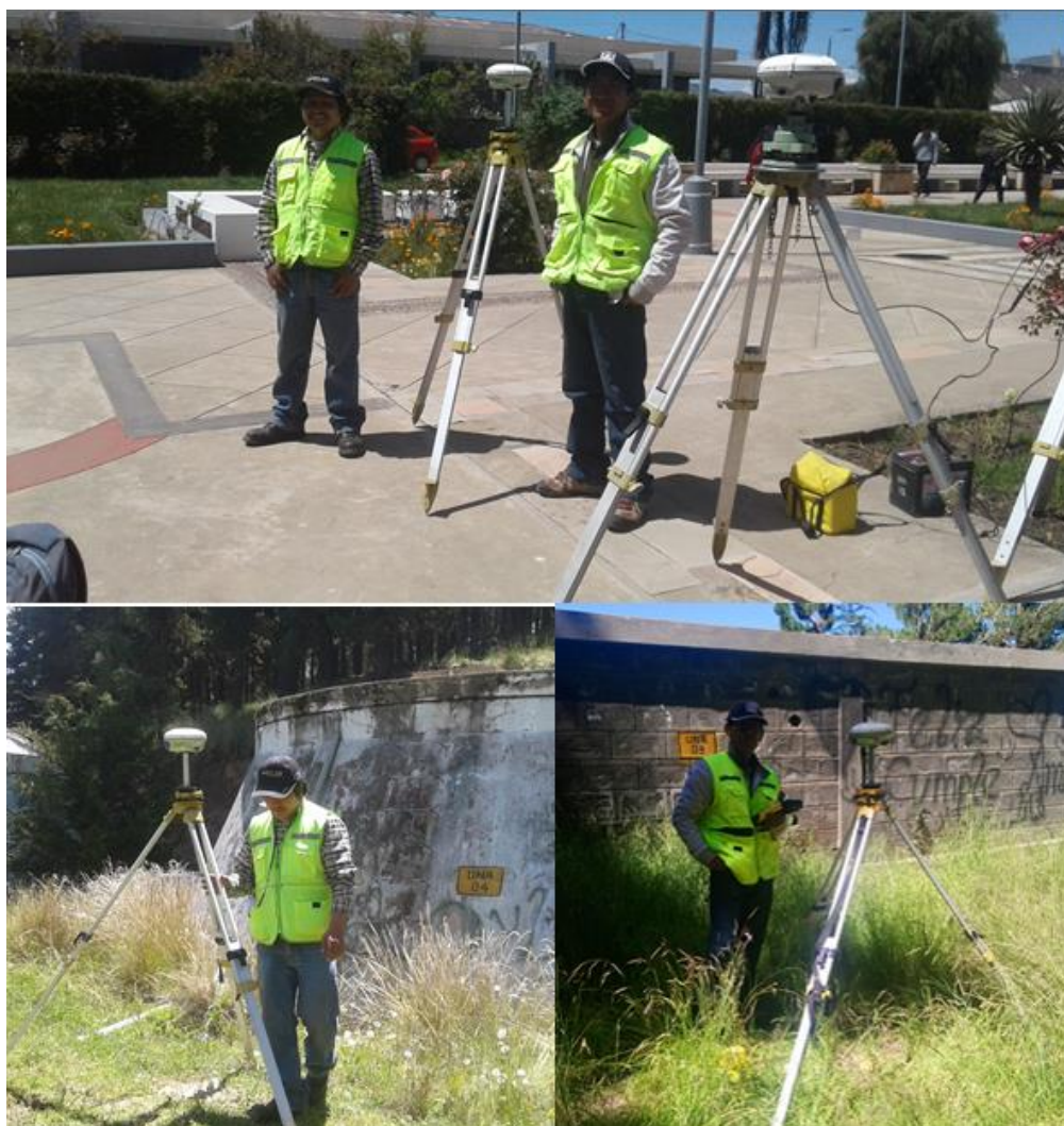
Figura 32 Obtención de puntos en modo RTK.
