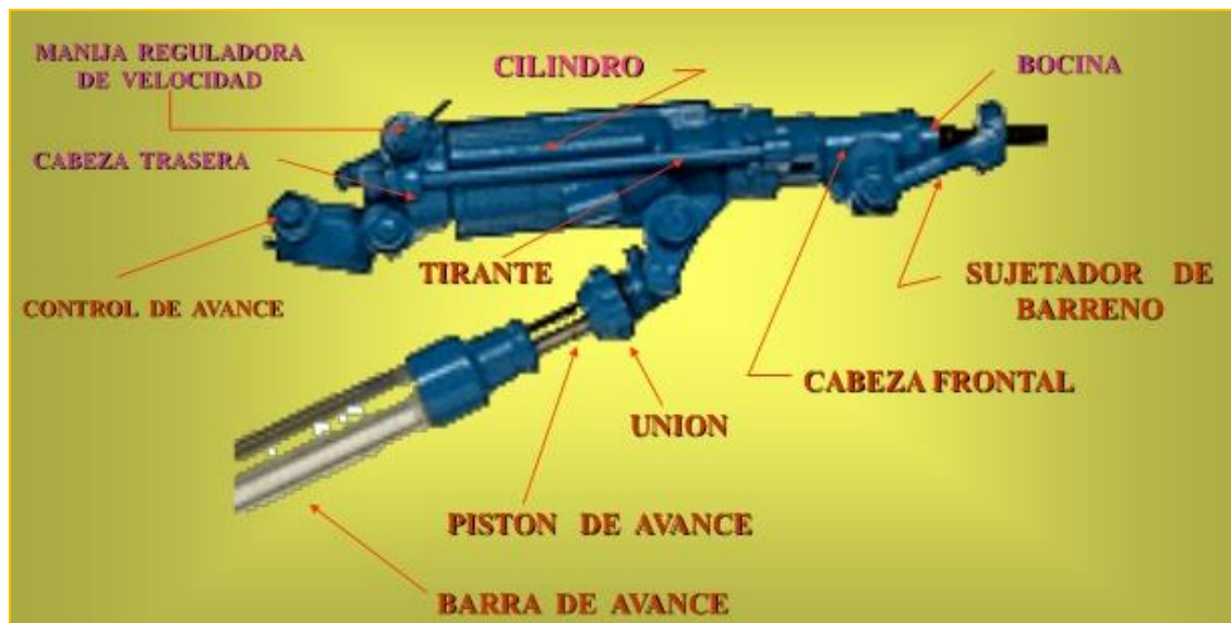
Figura 2. 2 Partes de una perforadora neumático
