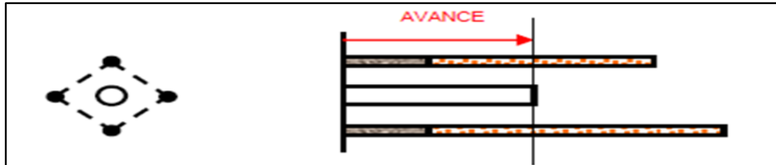
Figura 2. 8 Irregular longitud entre taladros
