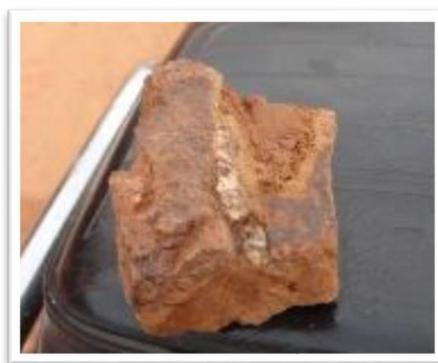
*Figura 52. Vetillas de cuarzo en la superficie de contacto con formación Muni.*
