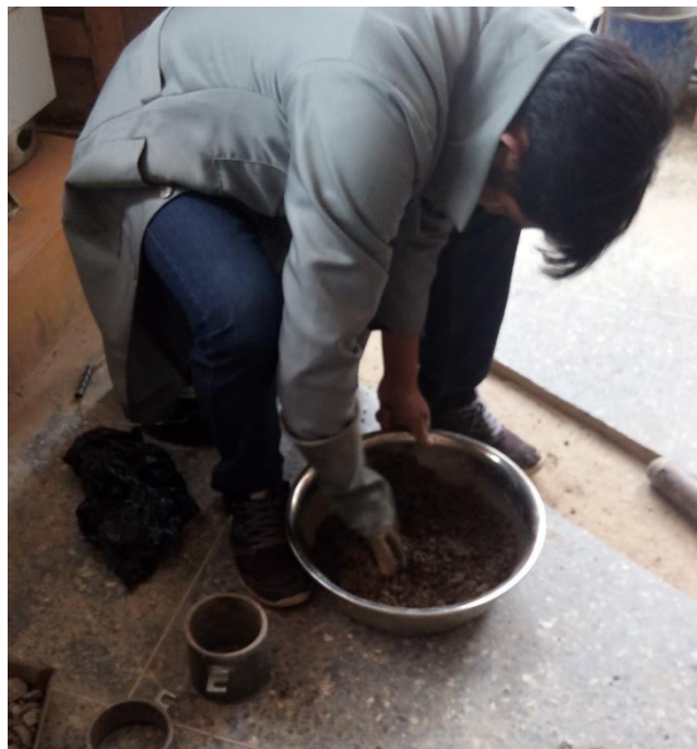
Foto 13: Mezclado de la muestra seca pasante de la malla #3/8 a diferentes porcentajes de agua.
