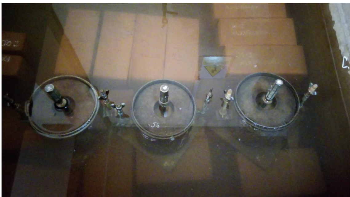
Foto 17: Después de obtener los moldes compactados se procedió a sumergir y hacer las lecturas con el extensómetro cada 24 horas para determinar la expansión.
