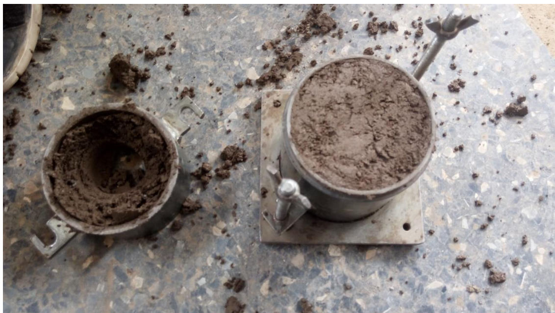
Foto 14: Para el método B se utiliza el molde de 4" y se compactó en 5 capas y 25 golpes/capa, obteniendo finalmente el molde compactado y se sigue el procedimiento de pesado.
