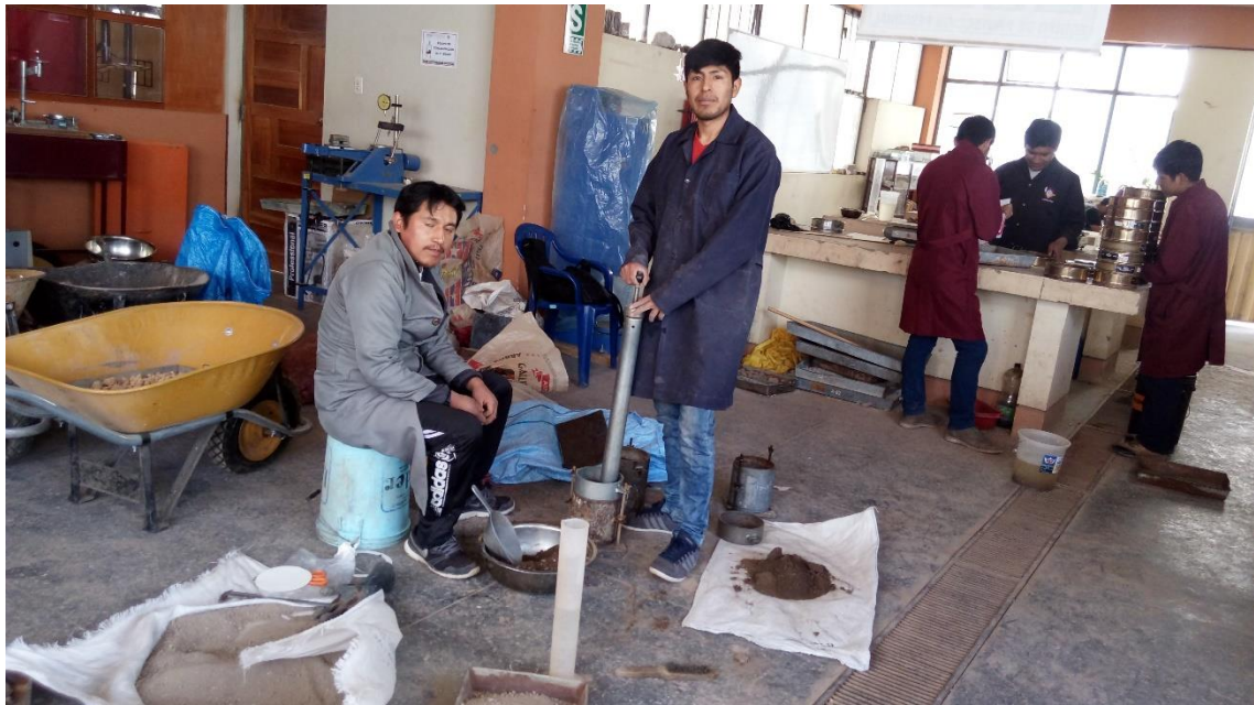
Foto 16: Procedimiento para cálculo de CBR a un contenido de humedad óptimo determinado en el ensayo proctor.
