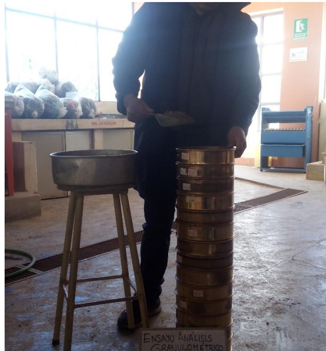
Foto 10: Procedimiento de Análisis Granulométrico por Tamizado después del secado en horno de la muestra.
