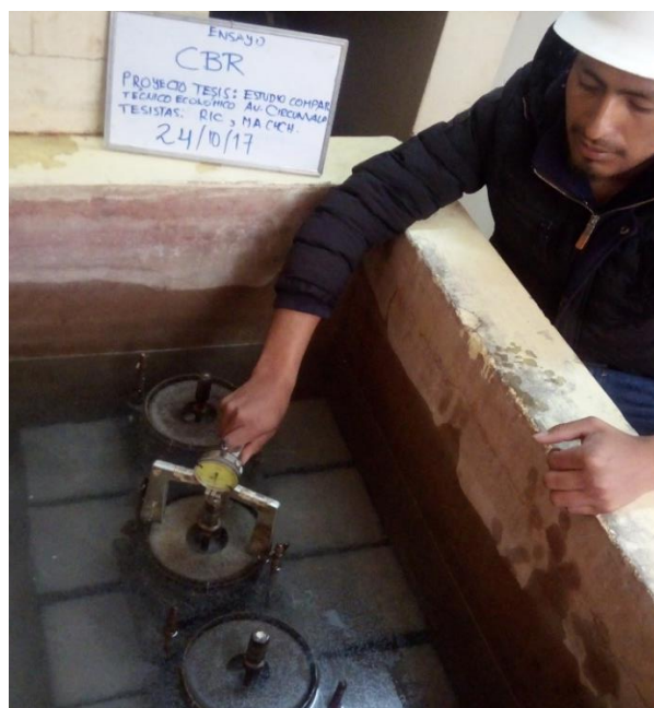
Foto 18: Lecturas con el extensómetro cada 24 horas para determinar la expansión.
