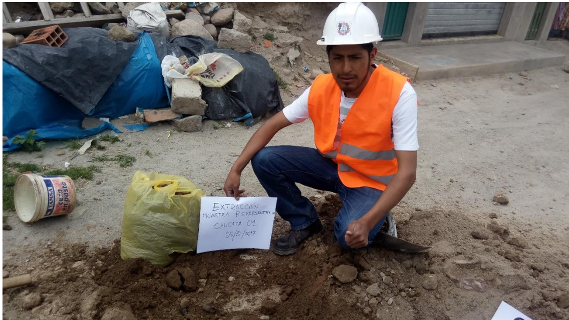
Foto 8: Se extrajo material representativo un aproximado de 70 kg. Por calicata.
