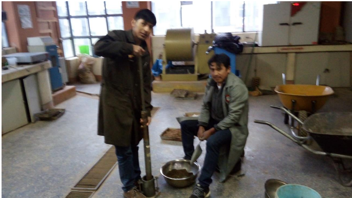
Foto 12: Procedimiento del ensayo Proctor Modificado, después de realizar el análisis granulométrico se obtiene realizar el ensayo proctor con el Método B a diferentes contenidos de humedad para obtener el contenido de humedad óptimo.
