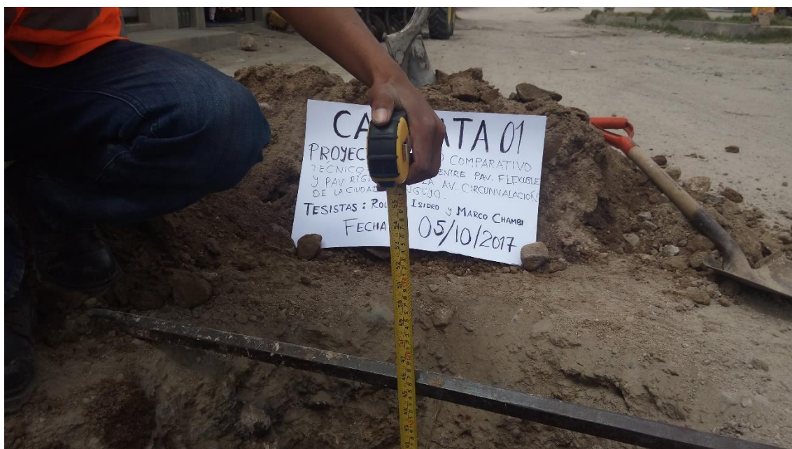
Foto 5: Verificando profundidad mínima de investigación 1.20m siguiendo recomendaciones de acuerdo al manual MTC E101-2000 (Pozos, calicatas, trincheras y zanjas).
