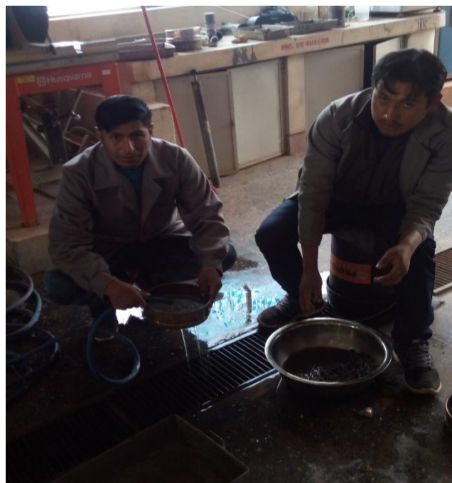
Foto 9: Procedimiento de lavado de la muestra para realizar el análisis granulométrico por tamizado.
