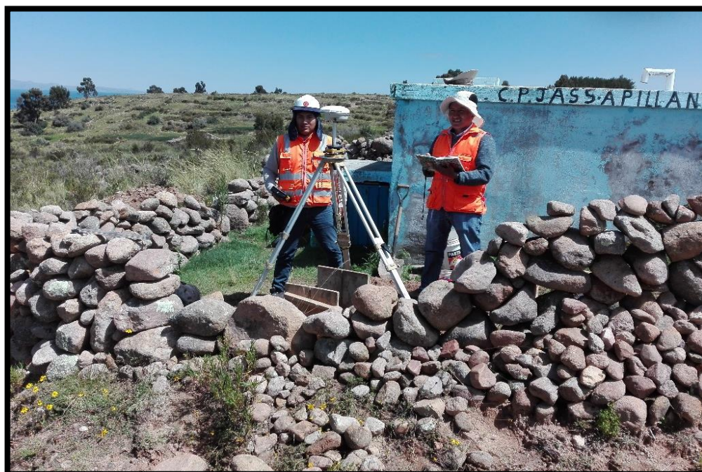
Figura 40: Posicionamiento del equipo GNSS en el Punto de Control Geodésico YUN 001.
