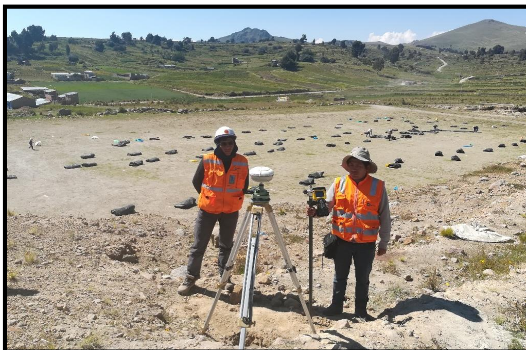
Figura 41: Posicionamiento del equipo GNSS en el Punto de Control Geodésico YUN 002.
