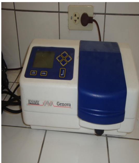
Figura 46. Espectrofotómetro para análisis, nitratos y fosfatos en el Megalaboratorio UNA Puno, mayo a julio 2016.
