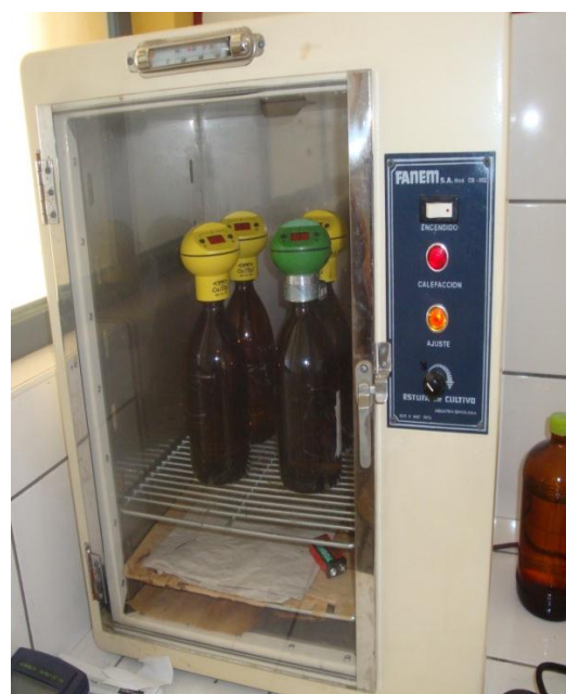
Figura 45. Método OXITOP para determinar DBO 5 procesado en el Megalaboratorio UNA Puno, mayo a julio 2016.
