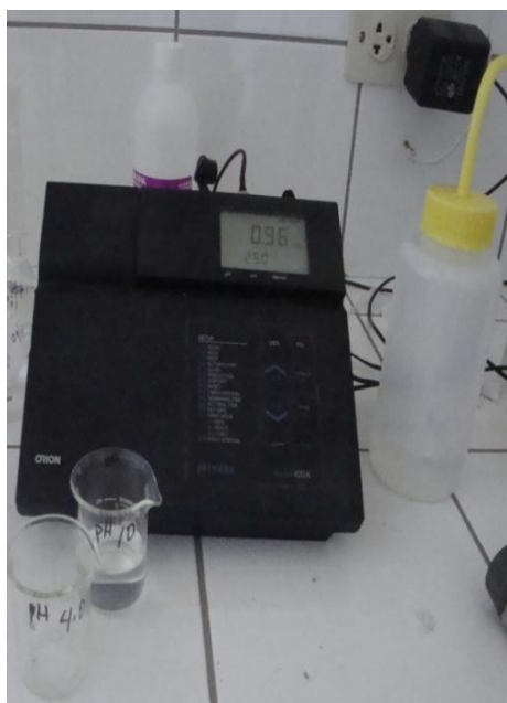
Figura 42. Potenciómetro para medir pH en el Megalaboratorio UNA Puno, mayo a julio 2016
