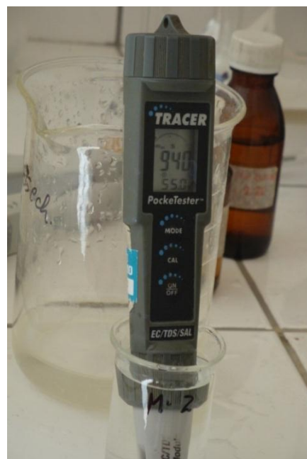
Figura 43. Multiparamétrico para medir SDT en el Megalaboratorio UNA Puno, mayo a julio 2016.
