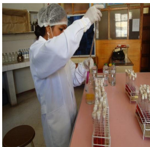
Figura 31. Inoculación de muestra de agua al caldo lactosado para determinar coliformes totales en el Laboratorio de Microbiología de Alimentos, UNA Puno, mayo a julio 2016
