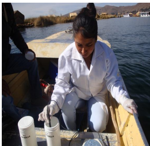
Figura 26. Lectura “ in situ ” con el oxímetro Termoficher Orion en la isla los Uros, mayo a julio 2016.
