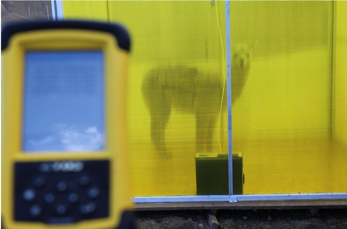
**FIGURA 15** Muestreo de CH<sub>4</sub> en la cámara de respiración herméticamente sellada, controlado con el PDA mediante conexión inalámbrica (bluetooth), vista frontal.
