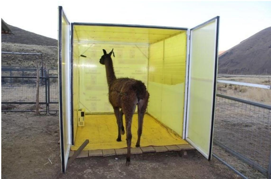
**FIGURA 14** Muestreo de CH<sub>4</sub> en la cámara de respiración, controlado con el PDA mediante conexión inalámbrica (bluetooth), vista lateral.
